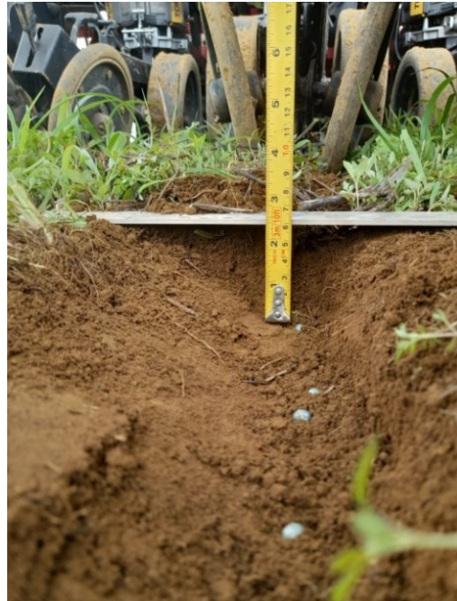
Figura 3. Medição da profundidade de deposição das sementes (SOUZA, 2024).
