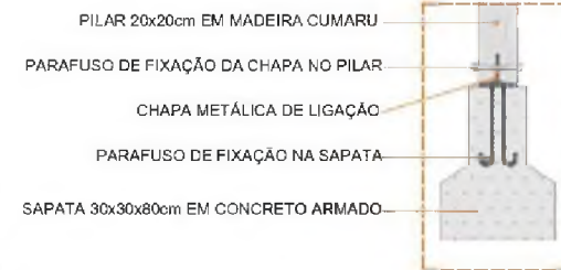
DETALHE FUNDAÇÃO DA GARAGEM ESCALA 1:25
