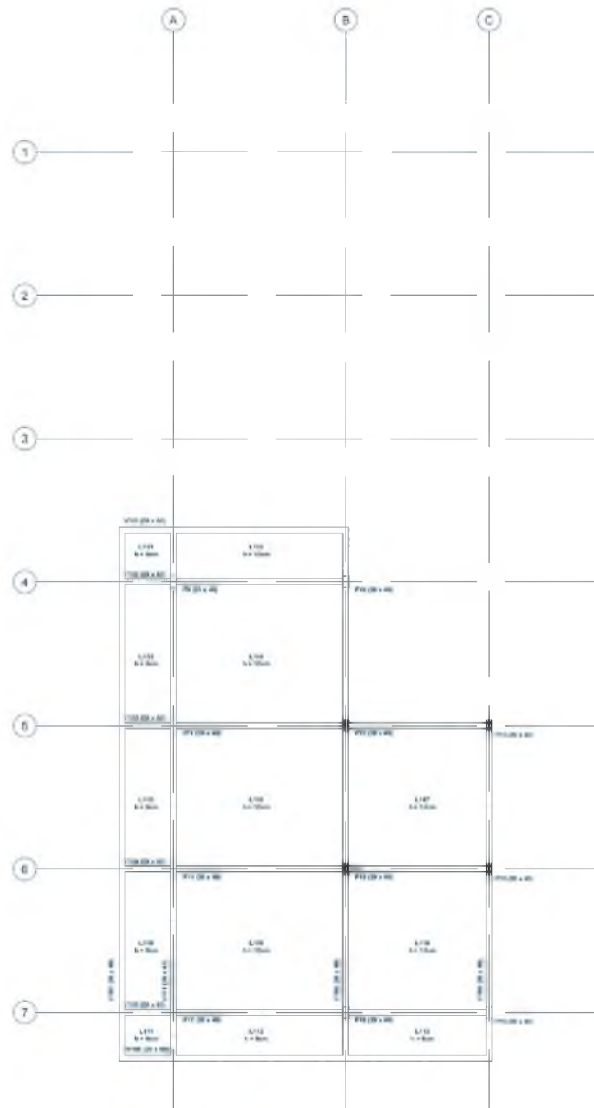
PLANTA DE FORMA - PRIMEIRO PAV. E/C: 1/200
