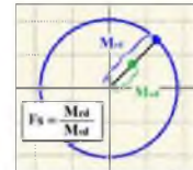
Figura: Esquema para determinação do fator de segurança (F.S.)
