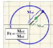
Figura: Esquema para determinação do fator de segurança (F.S.)
