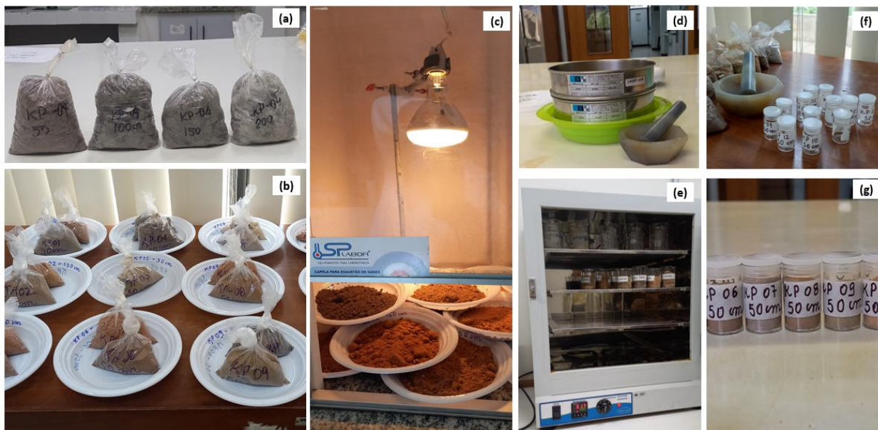
Figura 3.5 - Preparo das amostras para análise geoquímica dos solos: (a) amostra de solo (b) identificação das amostras para a secagem, (c) secagem das amostras para o peneiramento, (d) peneiramento e moagem do solo no almofariz e pilão de ágata, (e) secagem da amostra em estufa para ensaio Raios X, (f) frasco de acrílico utilizados para o solo moído, (g) fracos preenchidos e identificados com amostras em pó.
