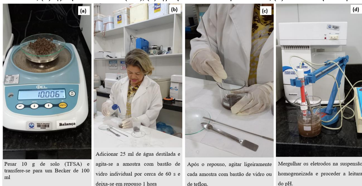
Figura 3.7 - Etapas realizadas na determinação dos solos segundo Embrapa (2017): (a) pesagem da amostra, (b) agitação da amostra (60s), (c) agitação da amostra para leitura, (d) determinação do pH.
