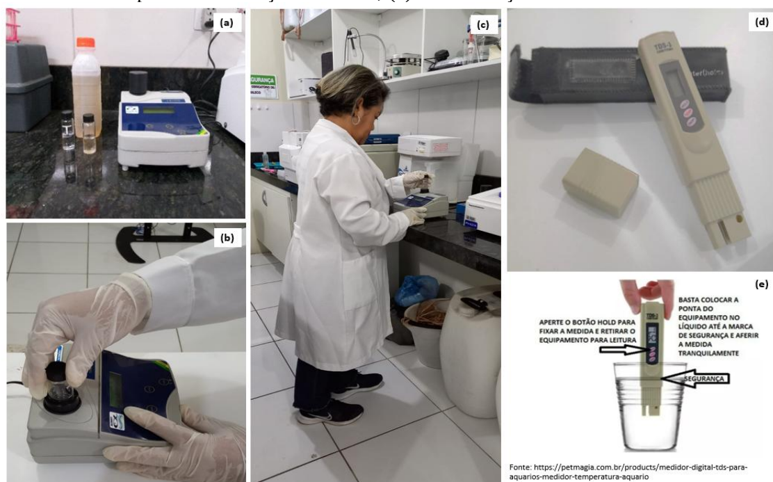
Figura 3.13 - Determinação da turbidez da amostra: (a) preparação do material a ser utilizado no procedimento, (b) realizando prova em branco, (c) realizando leitura da amostra, (d) caneta digital TDS-3 para determinação dos SDT, (e) determinação de SDT em amostra.
