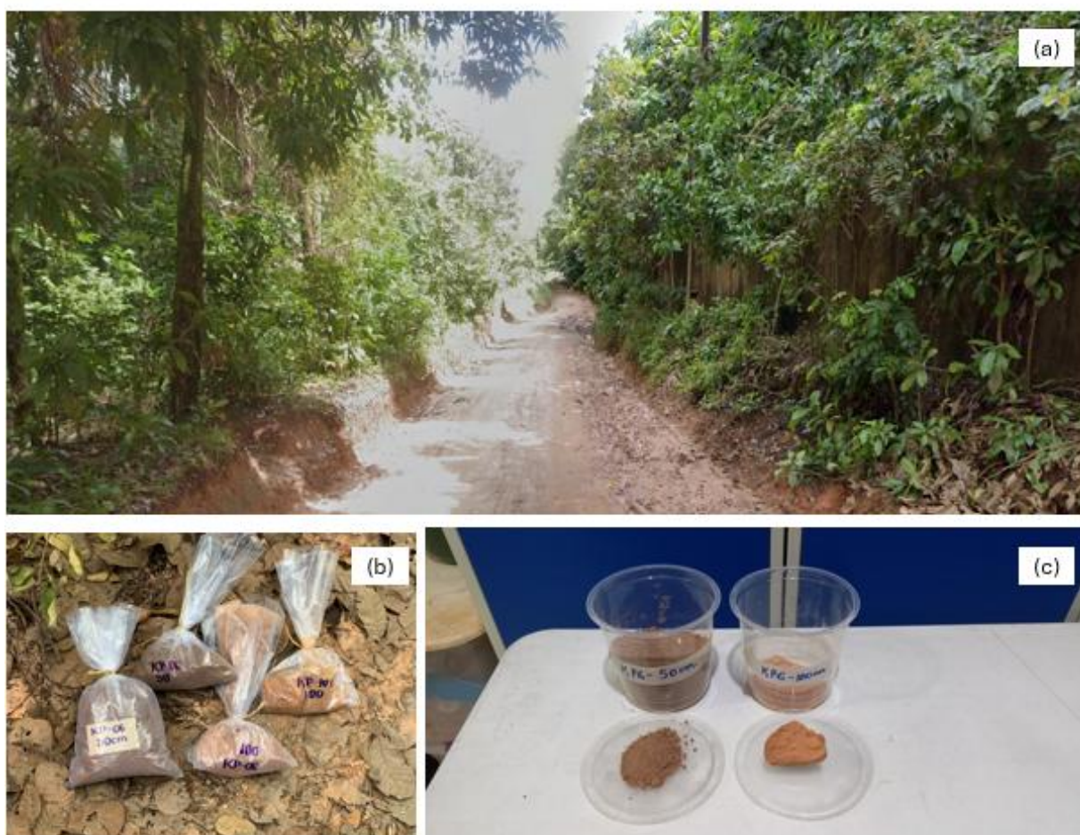
Figura 4.6 - Local de amostragem do ponto KP6: (a) visão geral da área; (b) amostras acondicionadas em plástico e etiquetadas para análises laboratoriais; (c) amostras secas para realização de ensaios.
