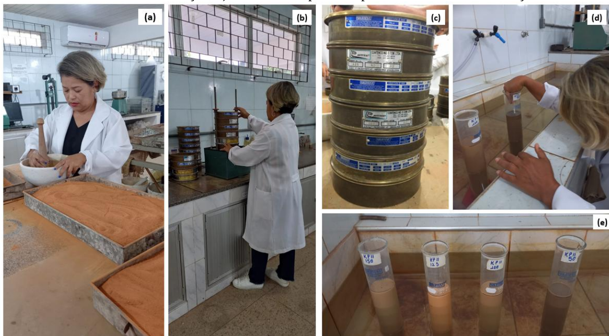
Figura 3.2 - Principais etapas na realização do ensaio de granulometria dos solos: a) preparo da amostra, b) peneiramento dos solos, c) sequência das peneiras do material grosso, d) leitura do densímetro no ensaio de sedimentação, e) amostras em provetas para o ensaio de sedimentação.
