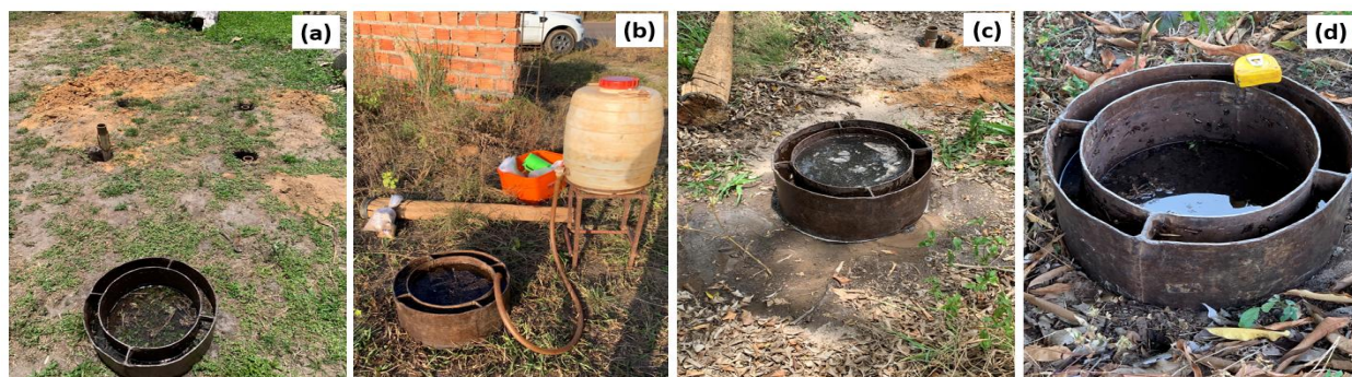
Figura 3.12 - Teste de infiltração dos anéis concêntricos: (a) cravação dos anéis no terreno, (b) preenchimento dos anéis com água, (c) anéis preenchidos com água no início do teste, (d) medição da lâmina com auxílio de uma trena.
