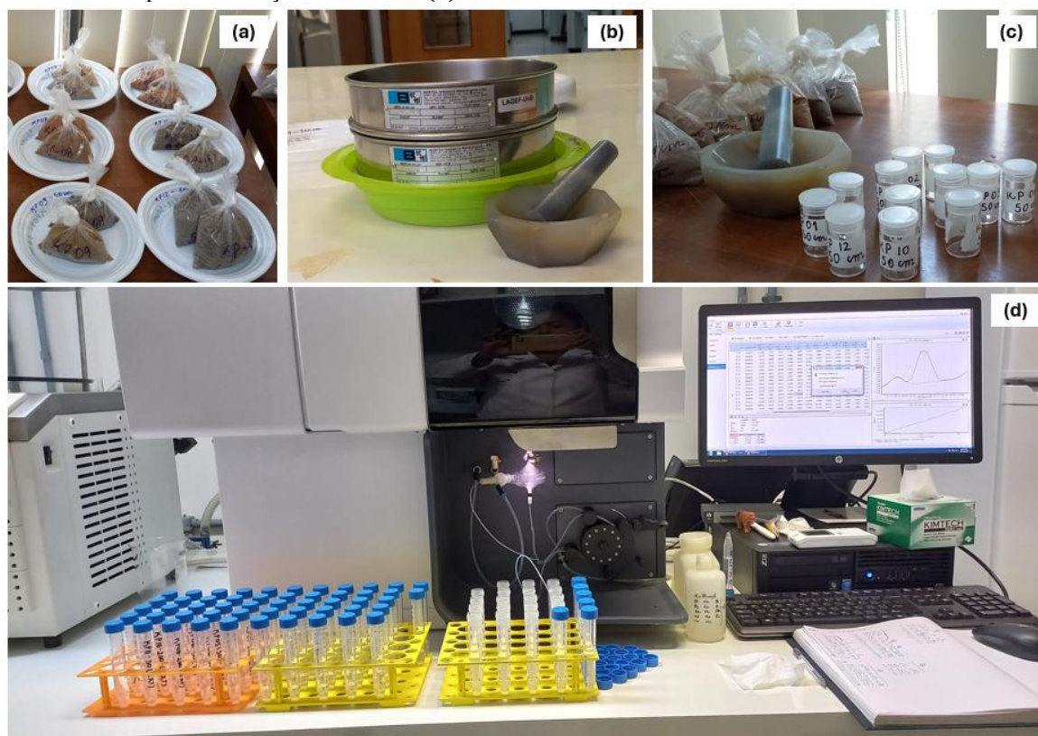
Figura 3.8 - Etapas para o processo de extração F1 - metais trocáveis: (a) amostras separadas para realização da análise, (b) peneiramento e moagem das amostras, (c) amostras moídas e acondicionadas para realização do ensaio, (d) momento de leitura no ICP-OES na UnB.
