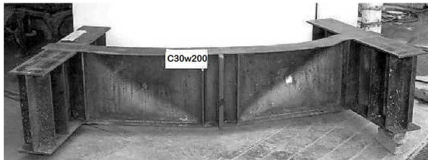
Figura 23 – Campo de tensões verificado em ensaios experimentais com vigas I curvas. Fonte: Shanmugam et al. (2003).
