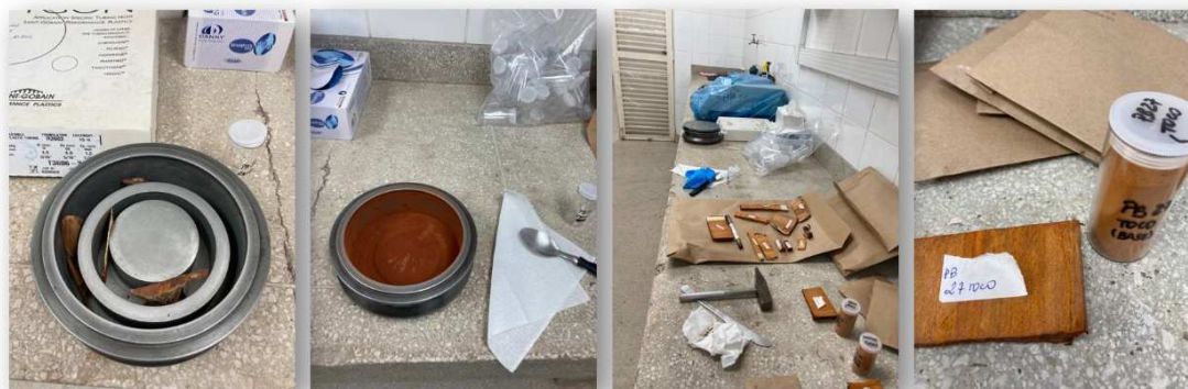
Figura 11 – Set de moagem – panela de tungstênio. Etapas do processo de moagem das amostras de madeira até a obtenção do pó. Amostra de pau-brasil.
