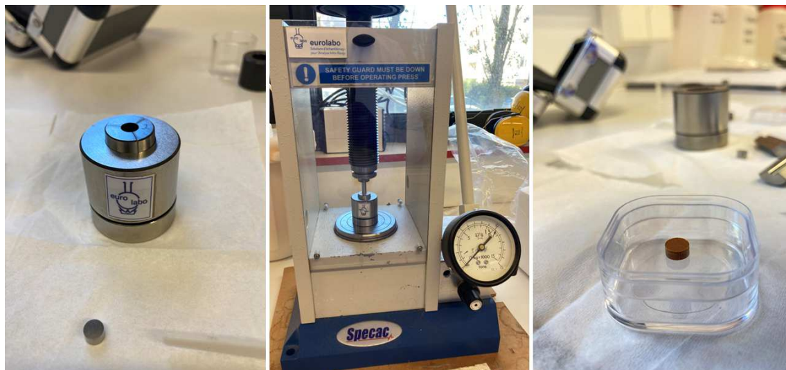
Figura 14 – Confeção dos pellets padrão in-house . Amostra PB24.
