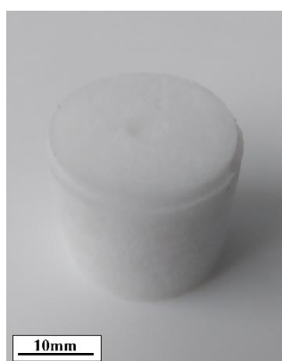
Figura 9: Fotografia do corpo de prova em formato cilíndrico para ensaio de compressão. Aerogel MC100.
