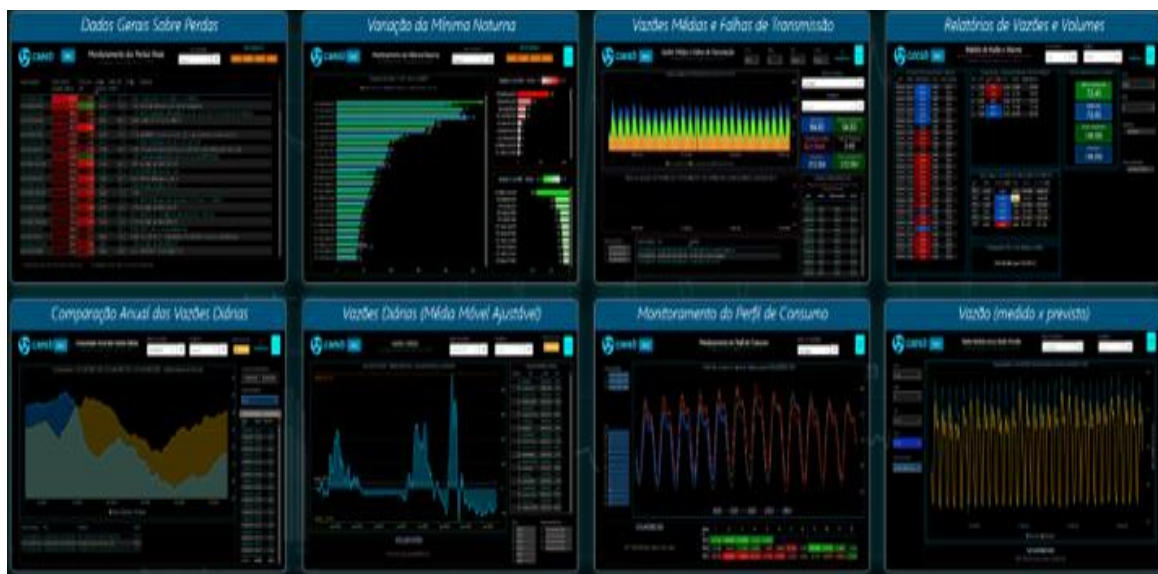
Figura 2.16 - Painéis de monitoramento de sistemas de abastecimento Fonte: Sistemas de Automação e Telemetria.
