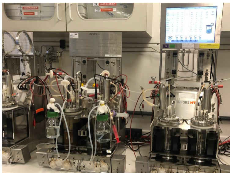
Figura 13. Bioreator Infors HT, modelo Multifors 2, utilizado para as fermentações com hidrolisado de bagaço de cana-de-açúcar.
