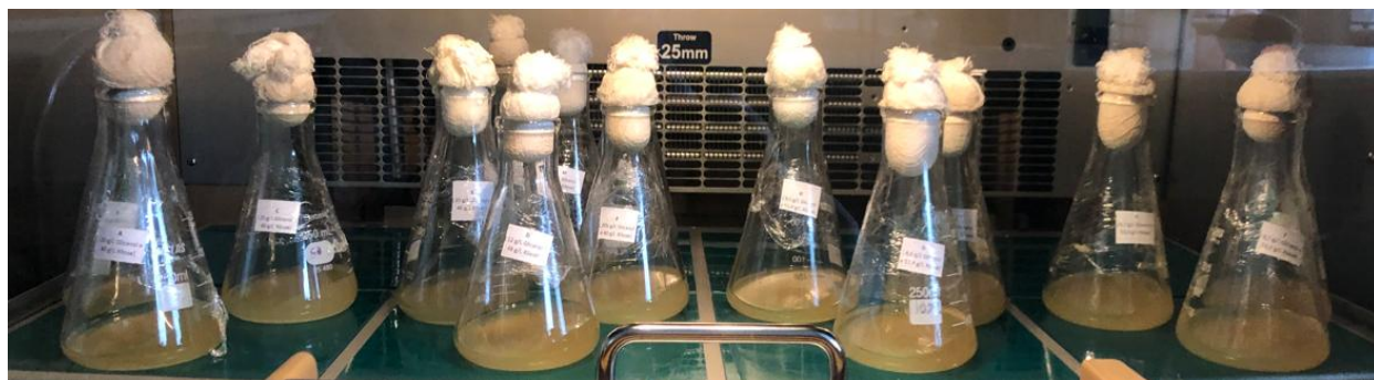
Figura 10. Fermentação em frasco Erlenmeyer de 250 mL, conduzida em shaker orbital, com a linhagem recombinante P1HL2, variando-se a proporção dos substratos glicerol/xilose.
