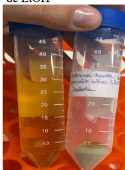
Figura 29. Etapas do processo de purificação do ácido xilônico obtido após a fermentação: (a) evaporação da água e concentração dos compostos no fermentado; (b) produto fermentativo após evaporação em banho-maria; (c) filtração a vácuo após adição de carvão ativado; (d) precipitação do ácido xilônico com EtOH (3:1 v/v); (e) separação entre sobrenadante e precipitado; (f) secagem do precipitado a vácuo por liofilização.
