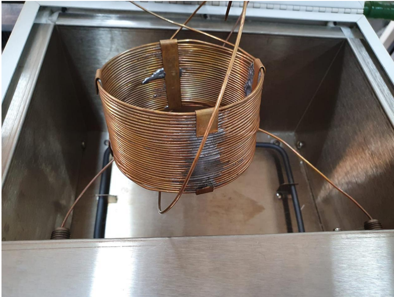
Figura 1- Imagem real do reator de cobre dentro do forno de CG.
