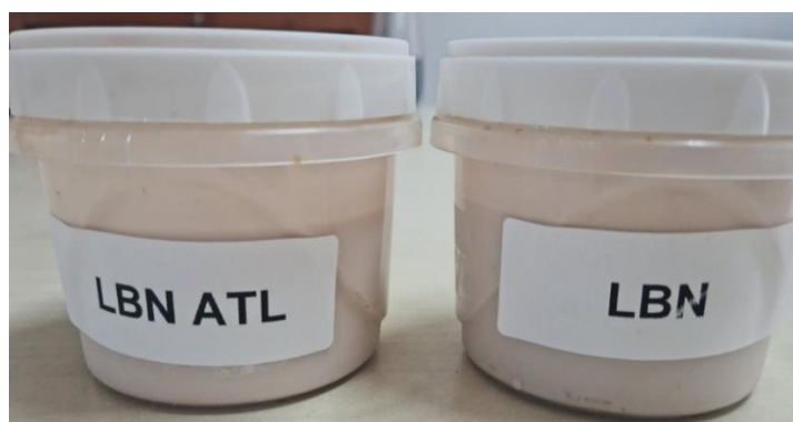
Figura 6- Látex tratado com tanino vegetal, à esquerda e látex tratado com amônia tingido, à direita
