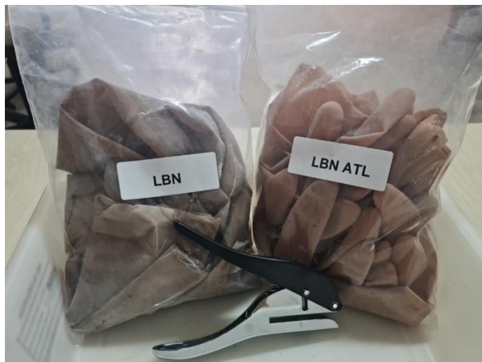
Figura 7- Filme tingido com corante vermelho à direita e filme tratado com tanino à esquerda junto ao perfurador utilizado para o recorte do filme.
