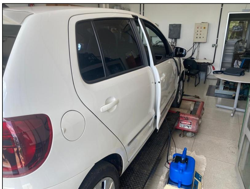
**Figura 3.8:** Teste do Dinamômetro - Consumo de Combustível
