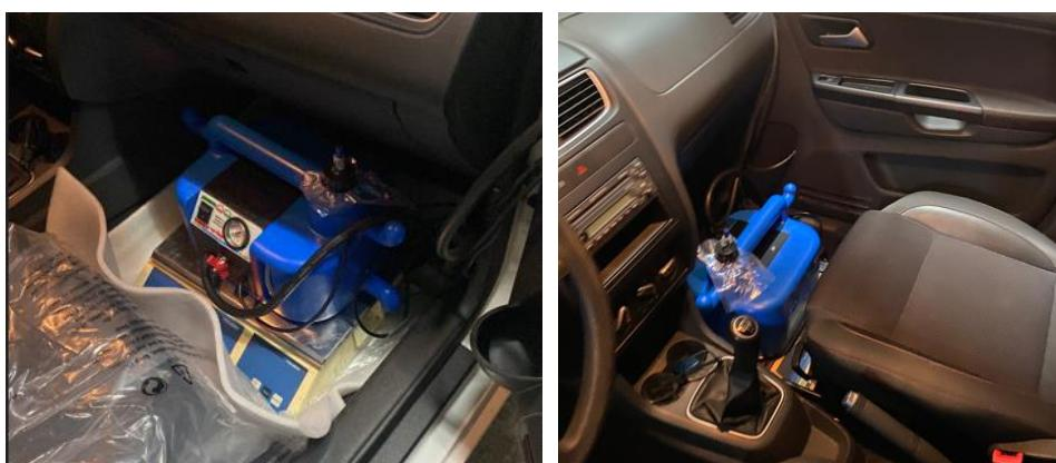
**Figura 3.5:** Medidor Externo de Consumo Acoplado ao Veículo
