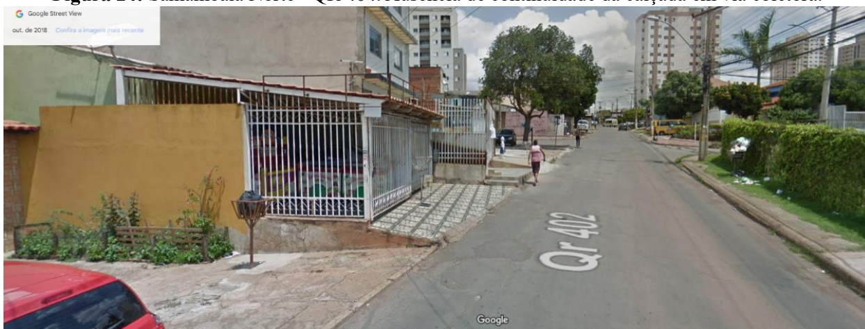
Figura 24: Samambaia Norte - QR 404. Ausência de continuidade da calçada em via coletora.
