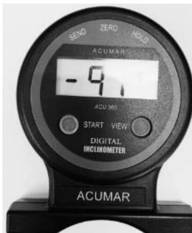
Figura 4. Inclinômetro Digital Acumar, Lafayette Instrument Co.
