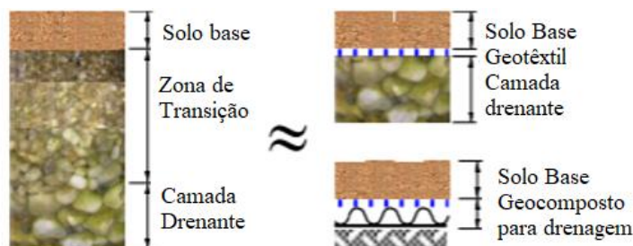
Figura 2.2-Filtro Granular vs. Filtro Geotêxtil (Modificado de Palmeira, 2023).
