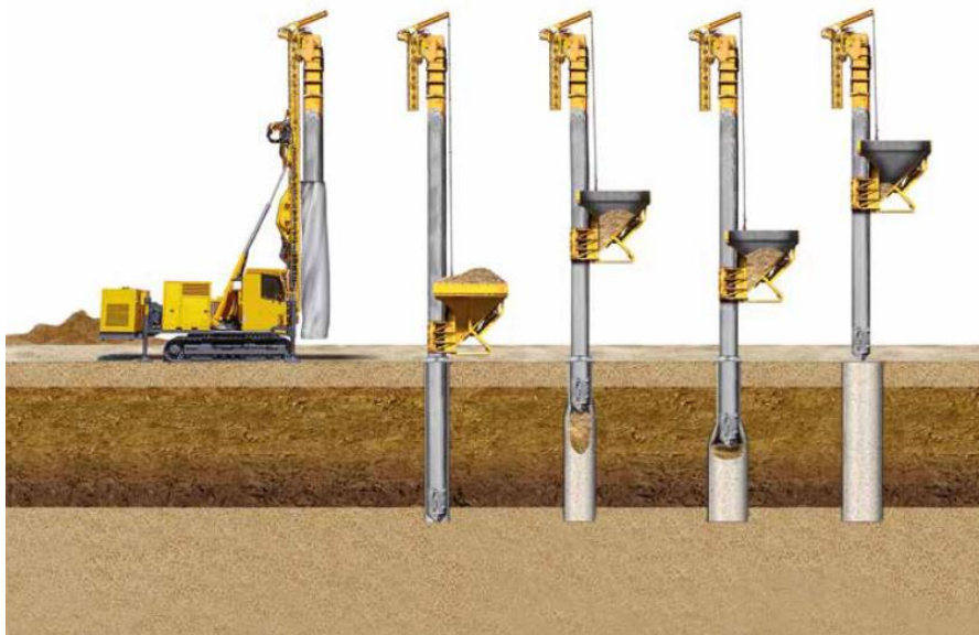
Figura 2.8. Execução da GEC por vibro deslocamento (Huesker, 2023).
