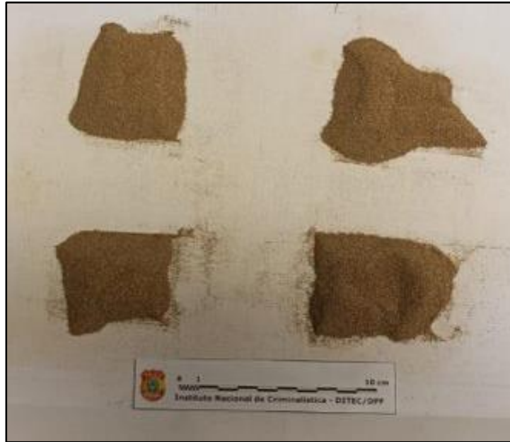
Figura 5.4. Quarteamento e homogeneização de amostra frível.
