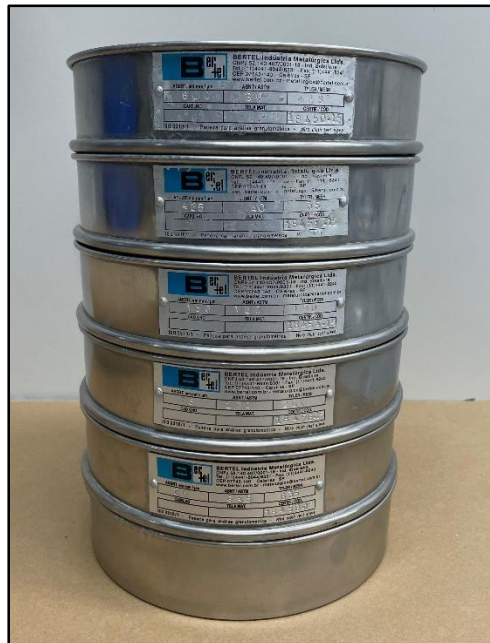
Figura 5.5. Separação granulométrica de amostra frível utilizando peneiras de 40 Mesh, 100 Mesh, 200 Mesh e 635 Mesh.
