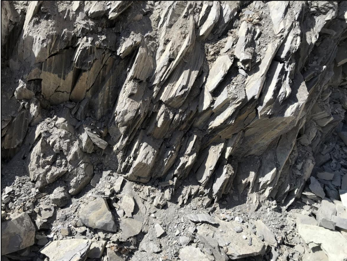
Figura 2.3. Frente de cava na localidade de estudo, evidenciando a foliação S_n na rocha encaixante (filito).
