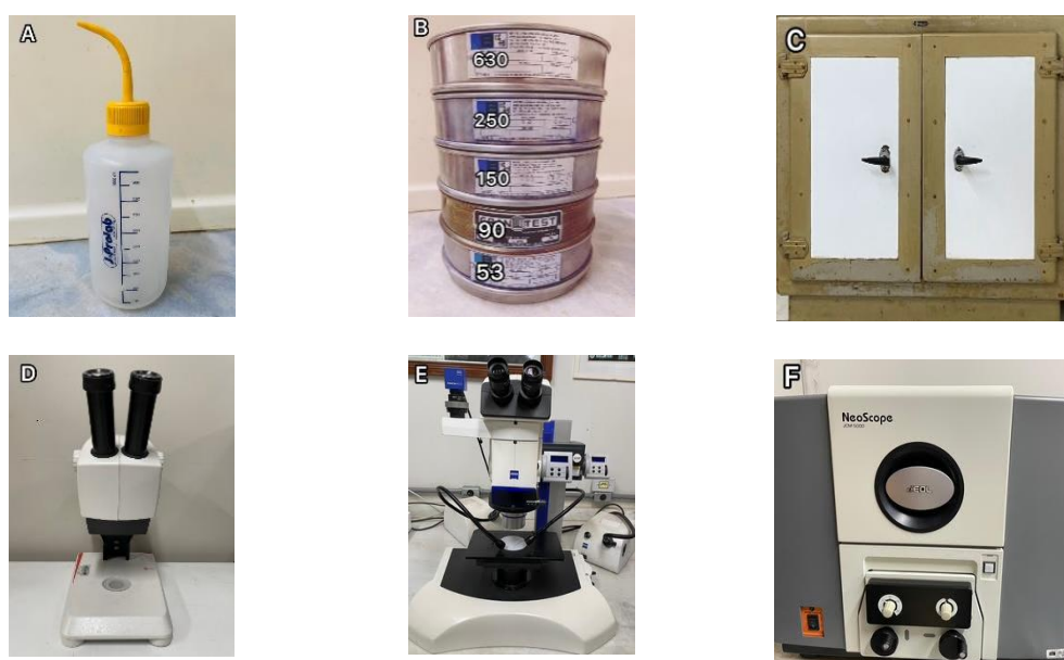
Figura 4. Materiais e métodos utilizados: a) Pisseta plástica com bico contendo peróxido de hidrogênio, b) Bateria de peneiras com malhas de 630, 250, 150, 90 e 53 \mu\text{m} , c) Estufa para secagem das amostras, d) Microscópio estereoscópico, e) Microscópio estereoscópico V20, f) Microscópio eletrônico de varredura (MEV).
