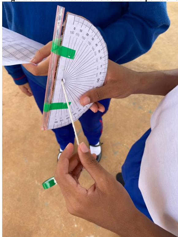
Figura 35 - Teodolito caseiro construído por aluno
