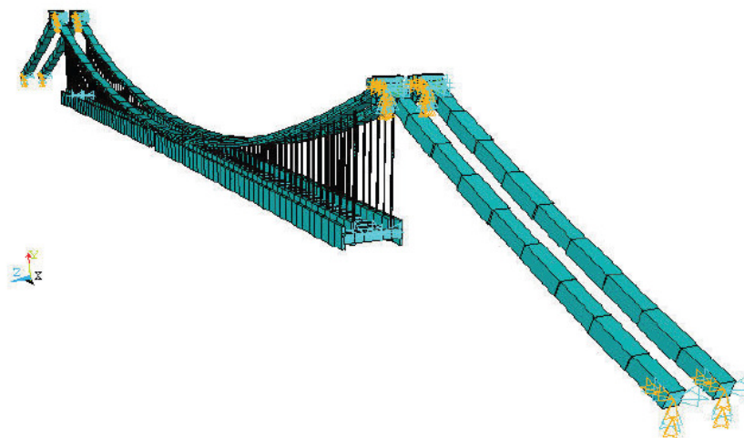
Figura 2.7 – Modelo inicial em elementos finitos, Merce (2007)
