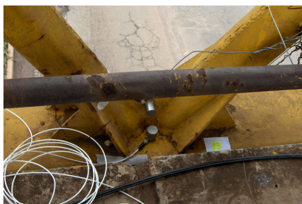
Figura 4.10 – Detalhe do posicionamento dos acelerômetros, Brasiliano et al. (2008)
