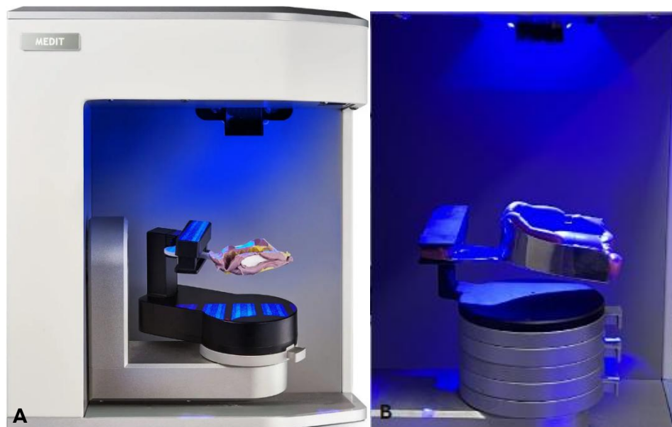
Figura 18: A. Scanner de bancada Medit T300 utilizado para realizar o escaneamento dos moldes de alginato. Fonte, Google 2025. B. Molde fixado no suporte do scanner de bancada para realização o escaneamento digital tridimensional.
