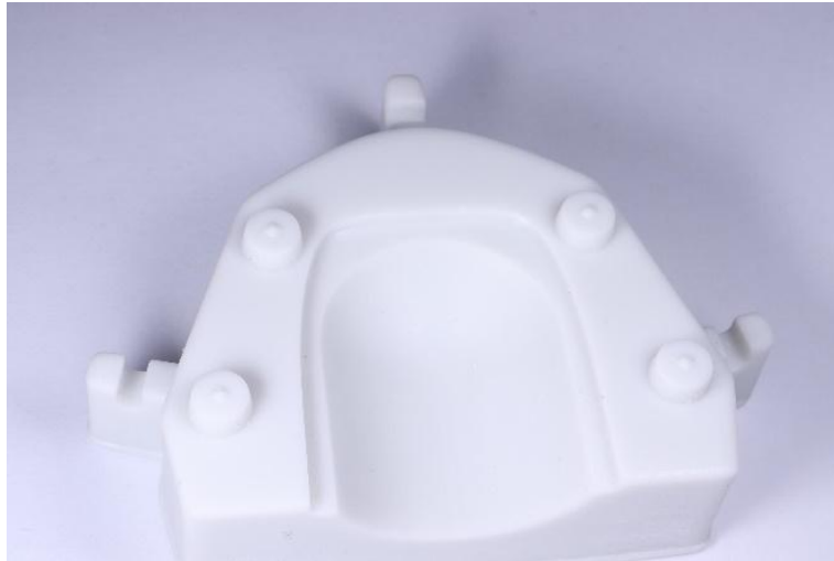
Figura 3: Modelo impresso com a resina de impressão 3D Dental Model.
