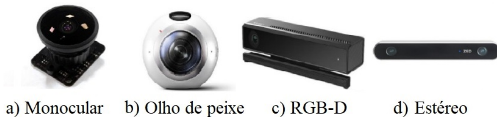
Figura 1 – Sensores visuais típicos. (a) câmera monocular, (b) câmera olho de peixe, (c) câmera RGB-D, (d) câmera estéreo (LU et al., 2018).
