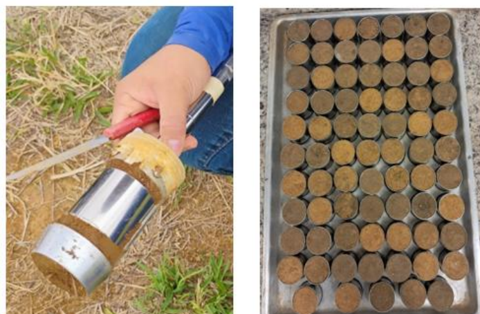
Figura 2. Amostragem de solo em anel volumétrico de 100 cm 3
