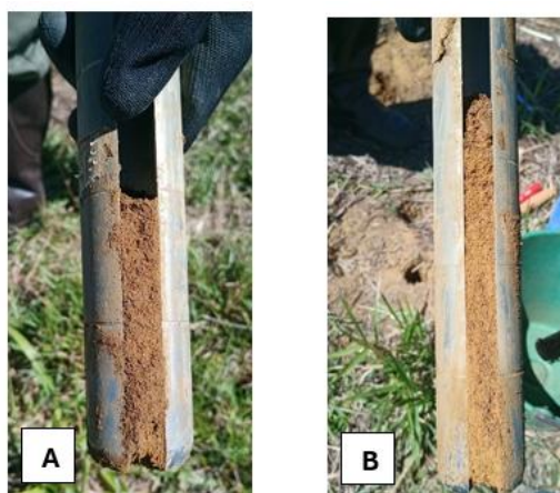
Figura 3. Amostragem de solo com trado calador para camada de 10 cm (A) e 20 cm (B).
