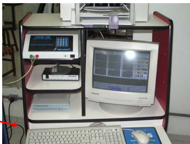
Figura 8: Analisador de gases (TEEM 100 ® – indicado pela seta), acoplado a um sistema de controle do teste ergoespirométrico.
