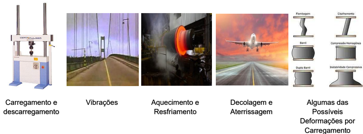
Figura 3.8: Comportamentos típicos de elementos associados ao fenômeno de fadiga.
