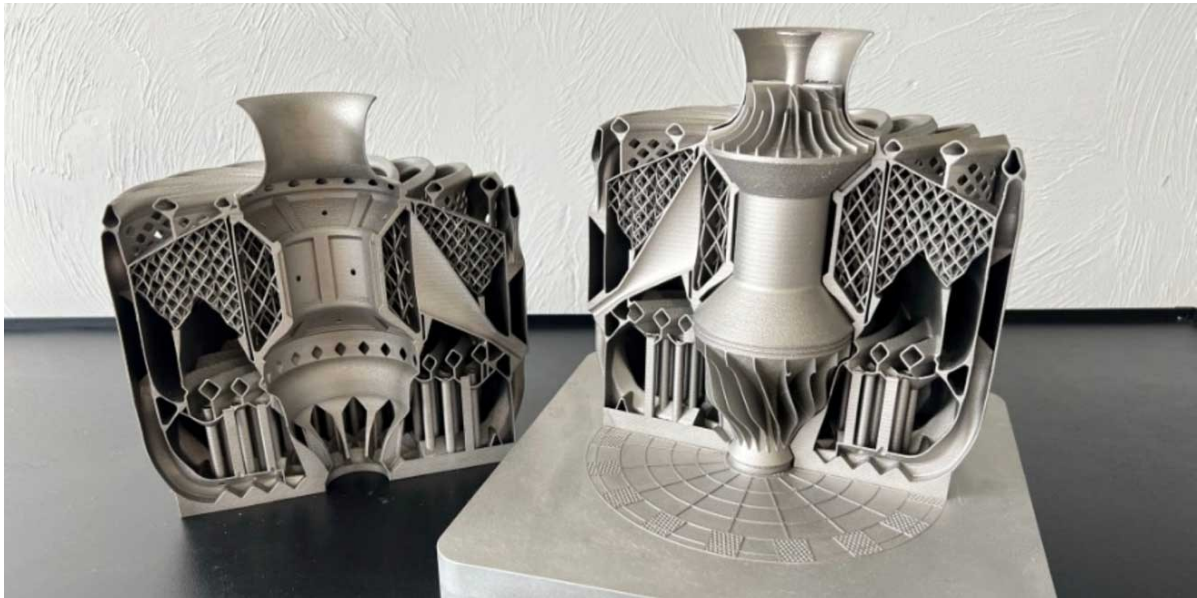
Figura 2.4. motor micro turbo fabricado por manufatura aditiva metálica. Fonte: Developmentscout. 2023.
