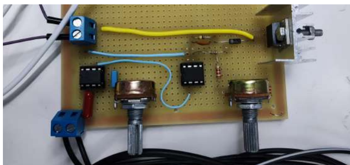
Figura 6.11. Primeiro circuito excitador construído na placa perfurada universal. O circuito consistia em um NE555 e um LM741 como driver do MOSFET IRFZ44n. Este transistor era responsável por chavear o primário do transformador flyback .
