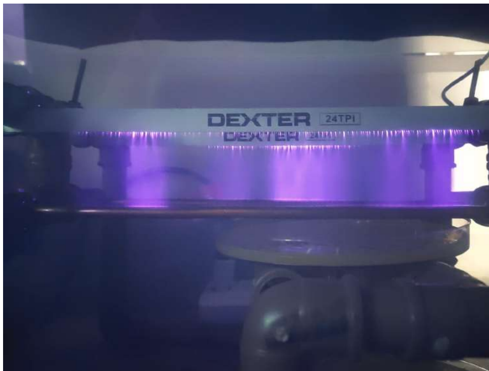
Figura 6.60. Aplicação da cortina de plasma em um recipiente fechado, de volume igual a 50 litros. A cortina de plasma consiste em dois eletrodos ativos, utilizando lâminas de arco de serra, e dois tubos de cobre como referência para o circuito de alta tensão. Uma estrutura em PVC foi construída para testar o alcance das espécies reativas em um ambiente fechado, com diferentes distâncias entre a placa e a descarga. O circuito excitador é o mesmo utilizado na caneta de plasma.
