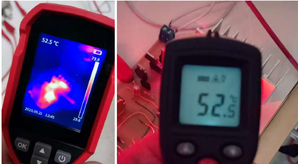
Figura 6.41. Na esquerda temos a temperatura do circuito vista pela câmera térmica, com o maior valor de temperatura no MOSFET, em torno de 52^{\circ}\text{C} . Já com o termômetro infravermelho diretamente acima do MOSFET, foi medido uma temperatura de 52^{\circ}\text{C} , após 20 minutos de operação contínua.
