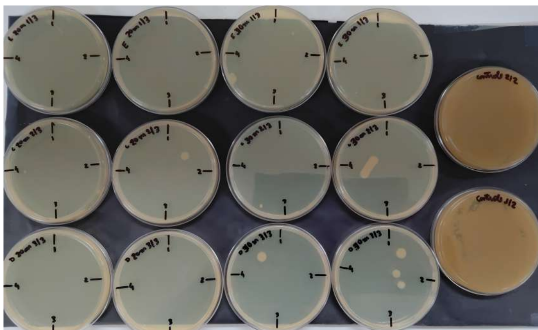
Figura 6.65. Resultado do tratamento com estufa de plasma, após 120 horas de incubação. As duas primeiras colunas, da esquerda para direita, trazem as placas expostas por 20 minutos, as duas colunas subsequentes as placas expostas por 30 minutos e a última coluna as placas de controle.
