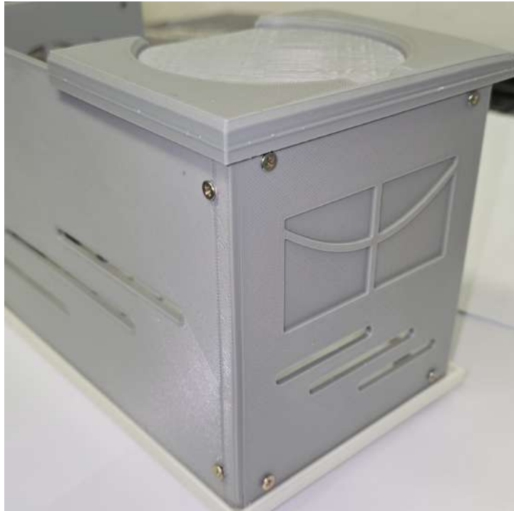
Figura 6.36. Detalhe lateral do sistema impresso. Aqui é possível observar como as peças se encaixam, sendo parafusadas na estrutura superior e inferior. Isto permite que parte do sistema seja desmontando e trocado, ou que todo o protótipo seja desmontado, para facilitar limpeza, upgrades ou reparos.
