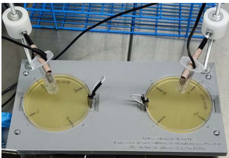
Figura 6.25. Estrutura atualizada da Caneta de Plasma, com base impressa em 3D, suportes metálicos isolados, espaços dedicados para as placas de Petri com conectores jacarês para aterramento do substrato. A utilização de barras roscadas possibilitam uma grande gama de distâncias possíveis.
