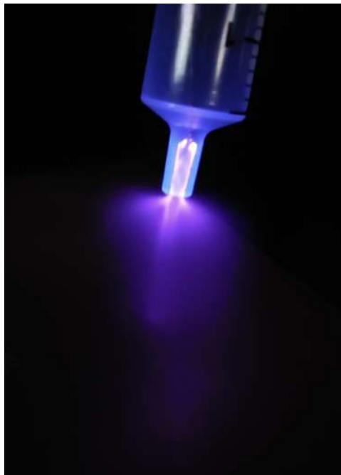
Figura 6.19. Descarga corona entre o eletrodo de alta tensão, no interior da seringa, e o plano de cobre abaixo, conectado à referência do circuito.
