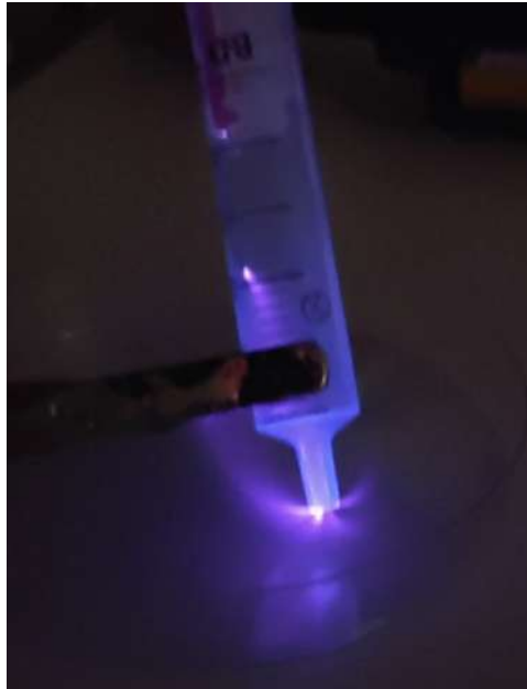
Figura 6.18. Demonstração do problema da atração eletrostática do Plasma ao eletrodo comum localizado na saída da seringa. É possível ver claramente a trajetória do plasma, sendo desviado abruptamente ao deixar a seringa.
