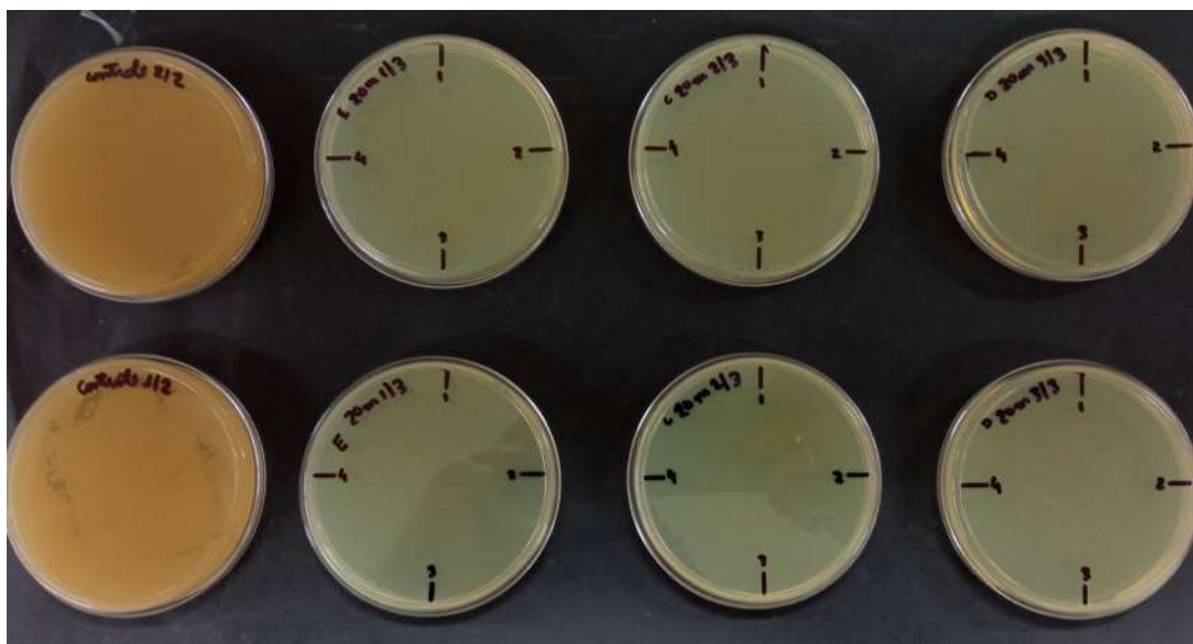
Figura 6.62. Resultado do teste com a estufa à plasma. À esquerda, temos as placas de controle, e em seguida as placas tratadas por 20 minutos. A segunda coluna traz as placas que estavam a uma distância de 170 mm da cortina de plasma, a terceira coluna tem as placas à distância de 50 mm, e a coluna mais a direita as placas à distância de 170 mm e ocultadas. É possível ver que, salvo colônias pontuais, 20 minutos de tratamento na estufa a plasma teve uma ação biocida significativa.
