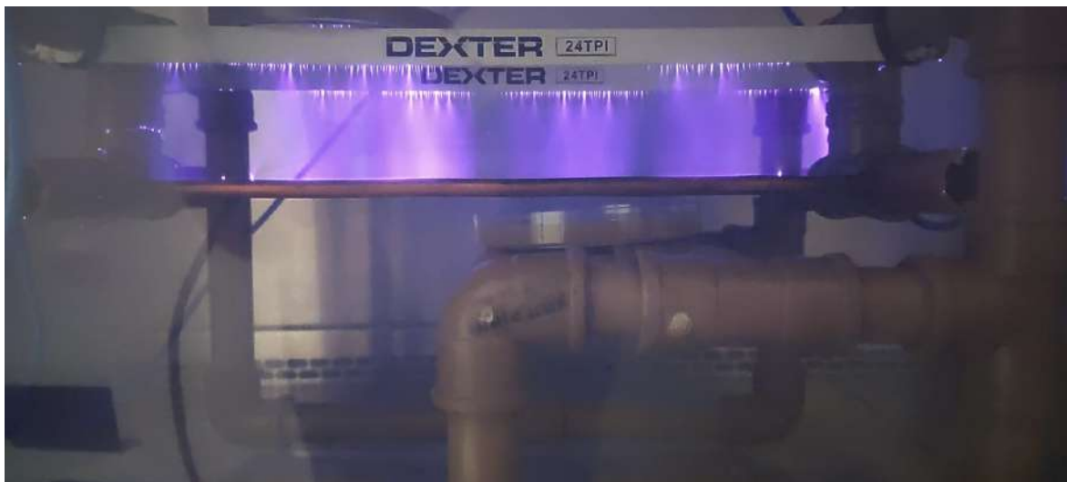
Figura 6.47. Detalhe da descarga do tipo cortina entre os eletrodos na parte interna da estufa. É possível observar também a placa Petri mais próxima dos eletrodos e a estrutura interna feita em PVC.
