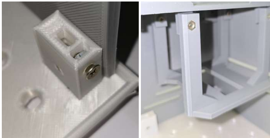
Figura 6.37. Detalhe do sistema de fixação da estrutura do protótipo, à esquerda, utilizando a união de peças impressas, com espaços dedicados para porcas, e parafusos padrão M3. À direita, o detalhe do suporte do transformador flyback , separado dos outros componentes para evitar danos internos.
