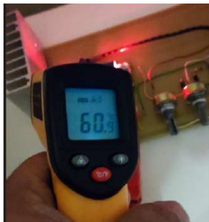
Figura 6.42. Tomada de temperatura do circuito, durante o teste para verificar o aquecimento dos componentes.
