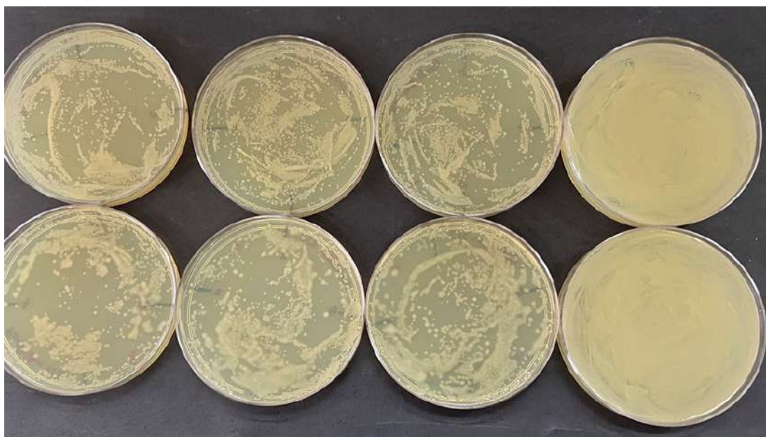
Figura 6.59. Detalhe do resultado deste primeiro teste com o eletrodo tipo “cortina”. É possível observar uma “uniformidade” ao longo do eletrodo, sem uma placa demonstrando um nítido efeito preferencial. A linha superior trás as placas expostas por 10 minutos, e a linha de baixo sua duplicata. As placas mais a direita trazem as placas de controle.
