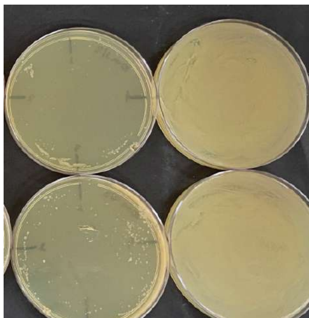
Figura 6.56. Detalhe do resultado do segundo teste com o segundo protótipo desenvolvido neste trabalho. À esquerda, temos o resultado após 10 minutos de exposição, e à direita o controle.
