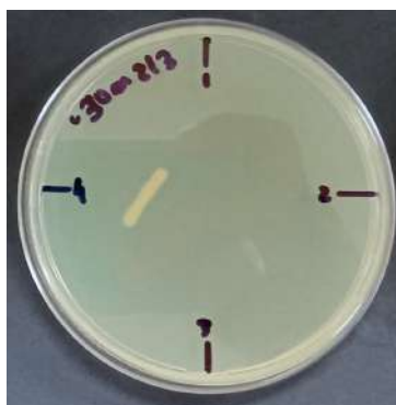
Figura 6.64. Detalhe do resultado do tratamento na estufa, após 30 minutos de exposição e 48 horas de incubação. A linha de crescimento dos contaminantes se deve à uma laceração na superfície do ágar, que permitiu a infusão dos contaminantes e a proteção destes contra as espécies reativas. Este resultado demonstra a ação superficial da descarga, não possuindo uma capacidade de penetração da ação biocida.
