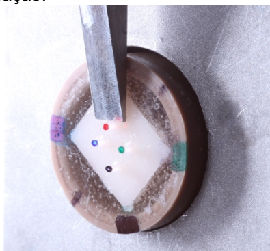
Fig. 27 – Cinzel adaptado na base da amostra durante o teste de resistência.
