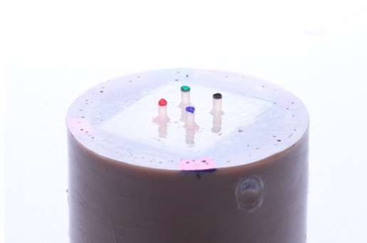
Fig. 24 – Aspecto dos postes de resina após a remoção do guia de silicone.
