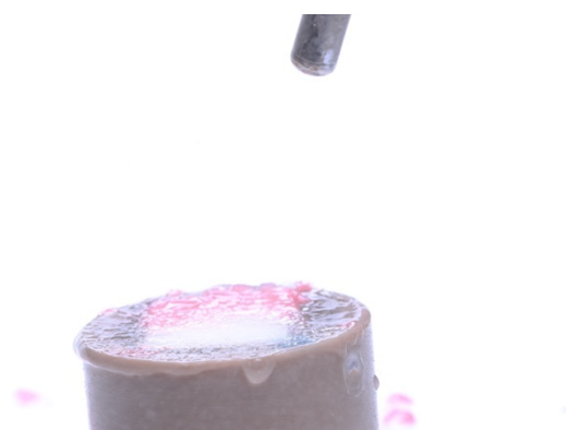
Fig. 10 – Lavagem do HF com jato de ar/água por 60 seg.
