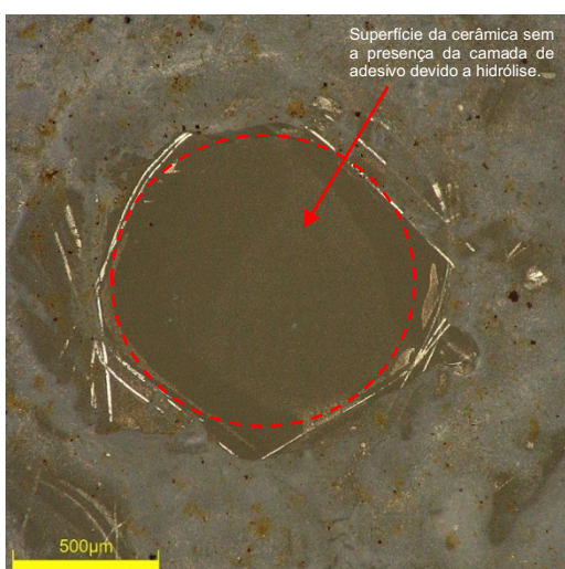
Fig. 43 – Imagem de superfície da pastilha cerâmica indicando falha do tipo adesiva – imagem 2D do grupo com saliva, sem termo_pré, HF10%, 20 seg, com termo_pós.
