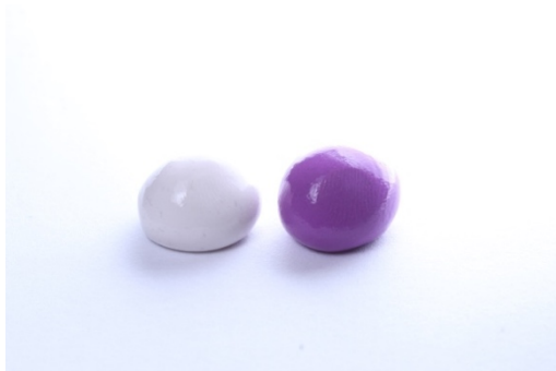
Fig. 17 – Proporção do silicone de adição.
