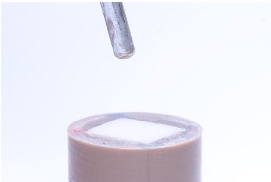
Fig. 15 – Leve jato de ar sobre o adesivo por 20 seg
