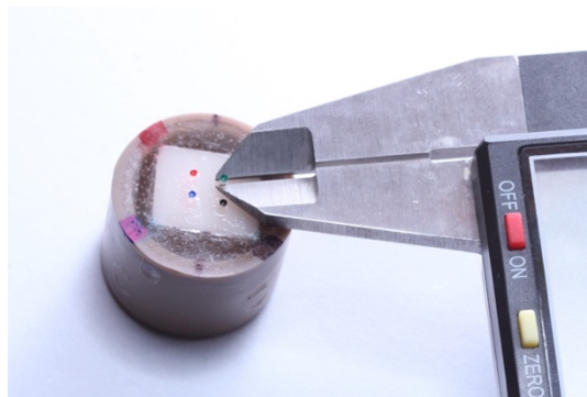
Fig. 26 – Medição do diâmetro de cada poste de resina com paquímetro.
