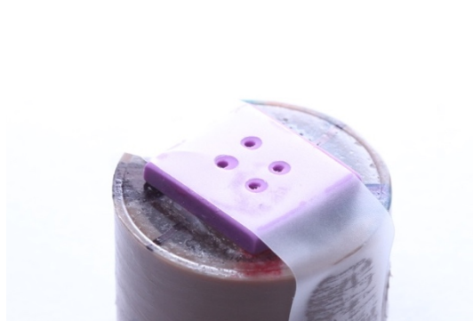
Fig. 20 – Guia e fita posicionados sobre a pastilha cerâmica.
