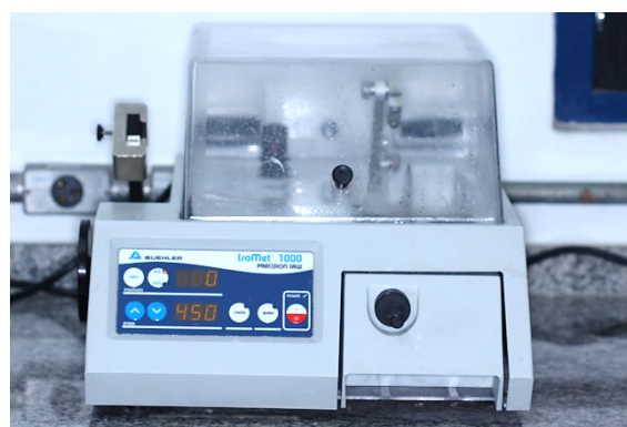
Fig. 2 - cortadeira metalográfica de precisão Isomet® 1000
