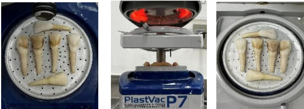
Figura 2. Processo de produção da moldeira.
