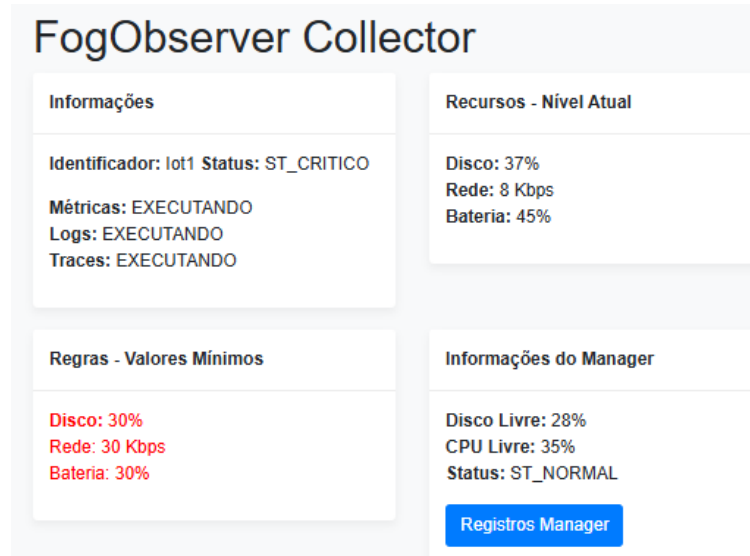
Figura 9.15: Interface do Collector evidenciando as informações usadas nas decisões adaptativas, assim como as mudanças de comportamento decorrentes.
