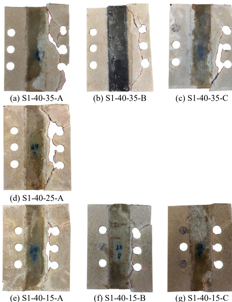
Figura 4.5 – Padrões de fissuração observados nos conectores da Série 1: (a) S1-40-35-A; (b) S1-40-35-B; (c) S1-40-35-C; (d) S1-40-25-A; (e) S1-40-15-A; (f) S1-40-15-B; e (g) S1-40-15-C.
