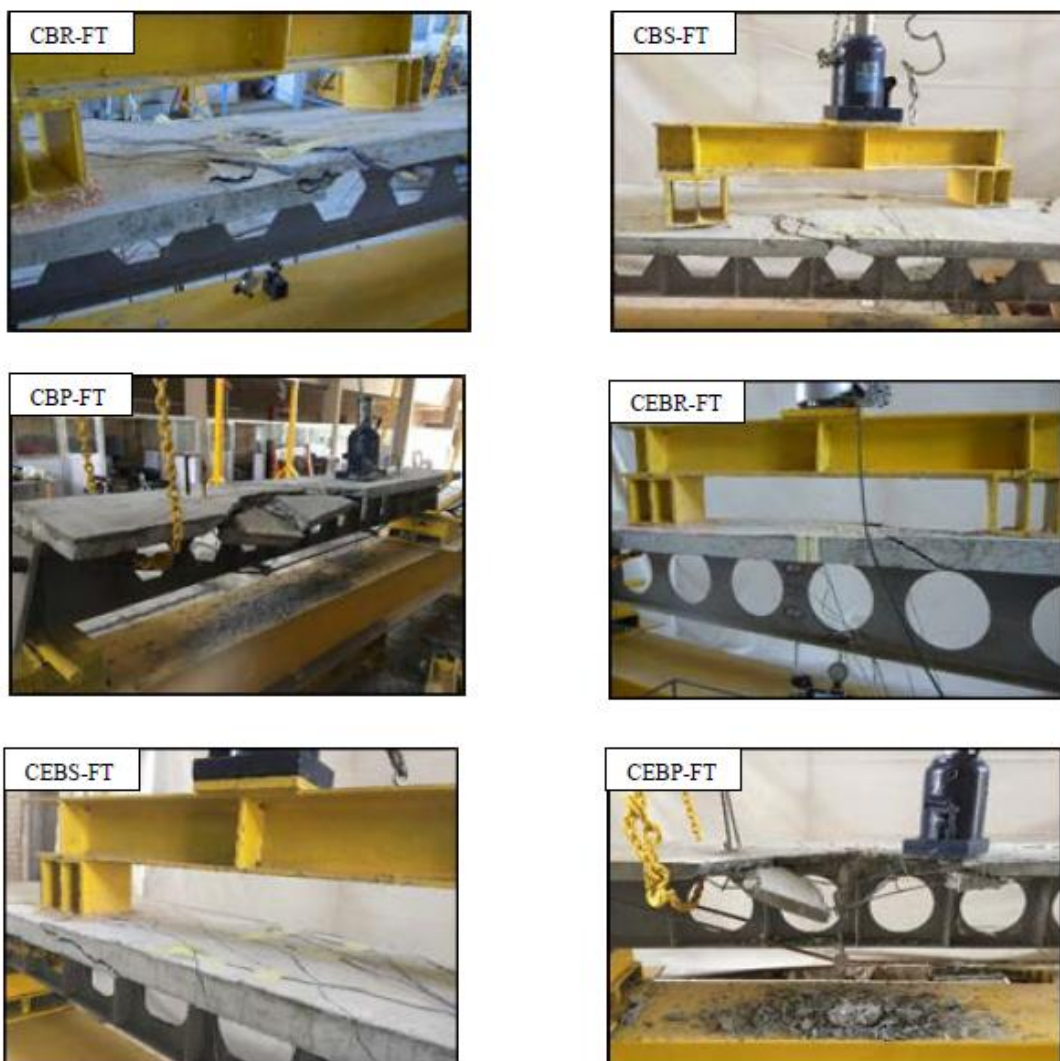
Figura 2.32 - Modos de ruptura dos ensaios experimentais (OUKAILI; ABDULLAH, 2018).
