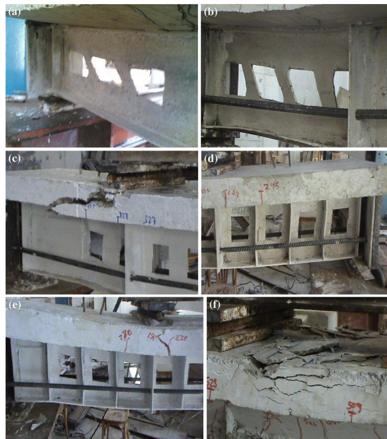
Figura 2.30 - Modos de falha de espécimes selecionadas. (a) Deformação da viga de referência sem pretensão e sem enrijecedores (b) Falha de end zone de espécime BIP50 (c) Falha da amostra BIP50p (d) Empenamento dos enrijecedores verticais da amostra BIIP25 (e) Falha da amostra BIIP50p (f) Falha de compressão da amostra BIIP25 (AFEFY; ATTA; TAHER, 2012).
