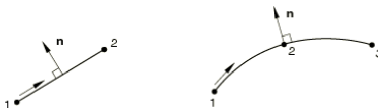
Figura 5.11 - Elemento TRUSS T3D2 (ABAQUS, 2014).
