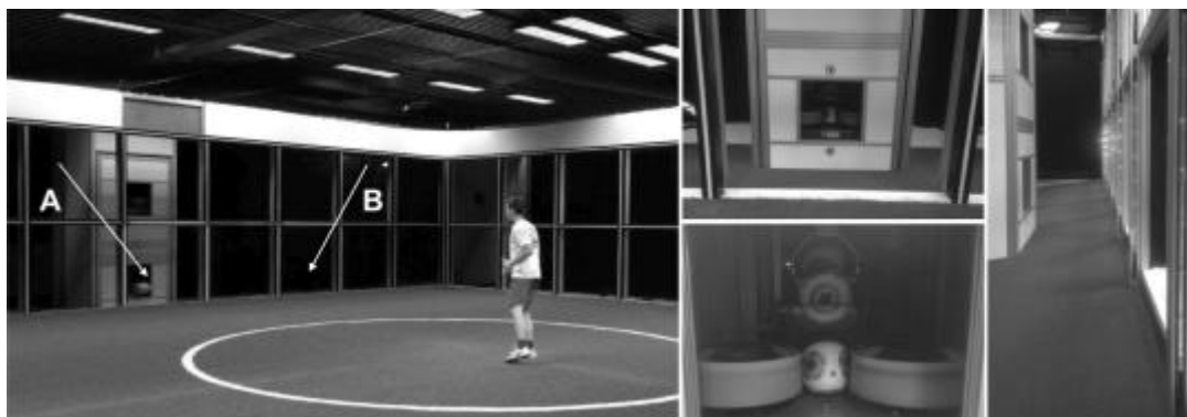
Figura 8 – Footbonaut área de teste, (A) lançador de bola, (B) painel alvo, visão detalhada das máquinas de lançamento de bolas e barreiras de luz (SAAL et al., 2018).
