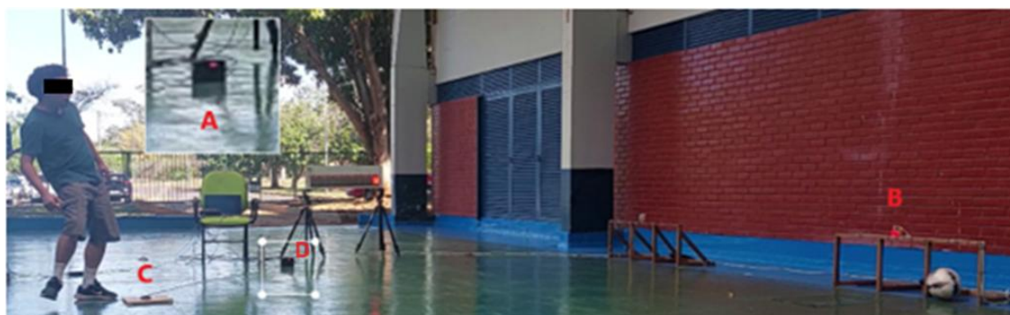
Figura 32 – Foto da execução de chute na plataforma de treino. (A) zoom do circuito sinalizador da saída da bola (D). (B) sinal luminoso de ultrapassagem da bola pelo alvo. (C) circuito secundário com sensor de saída da bola. (D) circuito sinalizador de chute.
