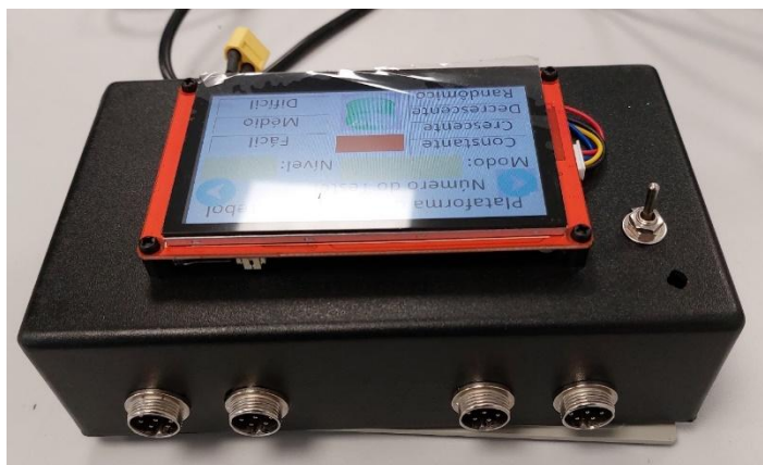
Figura 15 – Vista das saídas das conexões do painel temporizado e dos alvos.
