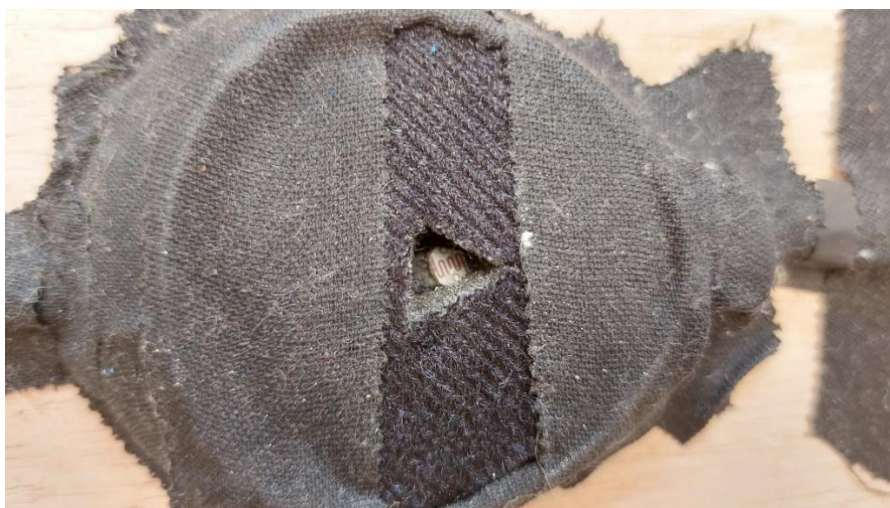
Figura 17 – Suporte da bola com sensor foto resistivo LDR ( light dependent resistor ).
