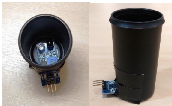
Figura 23 – Funcionamento do sensor de obstáculos reflexivo infravermelho.
