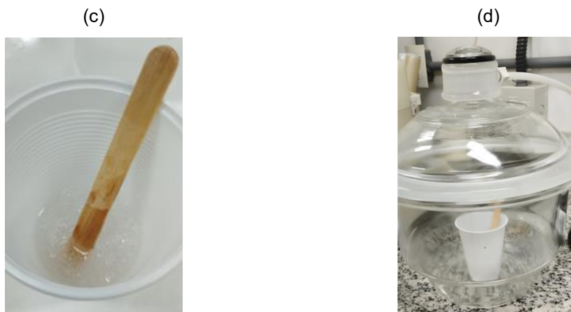
Figura 4.20: Preparação do PDMS. (a) SYLGARD™ 184 Silicone Elastomer. (b) Pesagem do polímero e do ativo. (c) Mistura e formação de bolhas. (d) Remoção de bolhas em dessecador a vácuo. Fonte: (a) [237]. As demais, o próprio autor.
