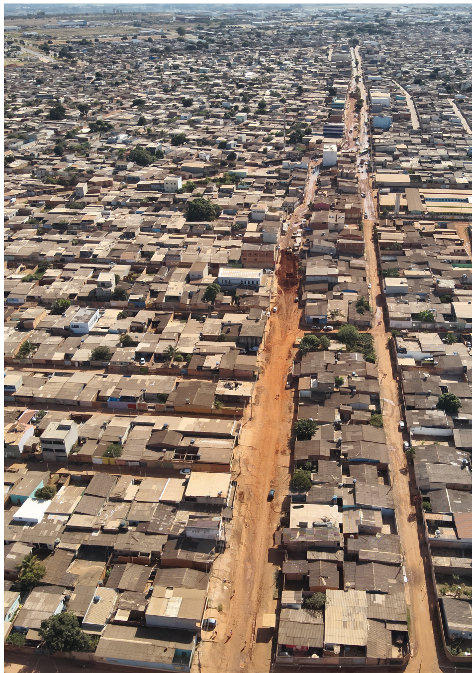
Figura 78: Avenida do Trem Bão, geradora de enxurradas no Trecho III do Sol Nascente
