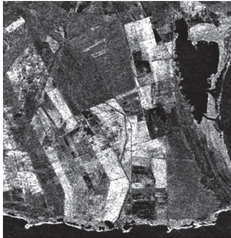
Figura 3.21. Presença do ruído speckle (aspecto de sal e pimenta em toda a imagem) em uma cena do satélite canadense Radarsat-1 da região de Lagoa dos Patos, RS.
