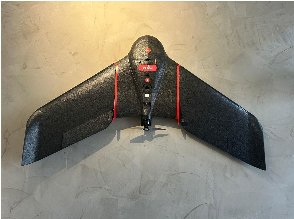
**Figura 9.** VANT (Veículo Aéreo Não Tripulado) Ebee Ag (Sense Fly) utilizado nos ensaios. O drone Ebee AG vem acoplado com lente NIR (Near Infrared - Infravermelho Próximo) para a captação de fotografias em NDVI (Índice de Vegetação por Diferença Normalizada). **Prisma Inteligência Agronômica, 2024.**
