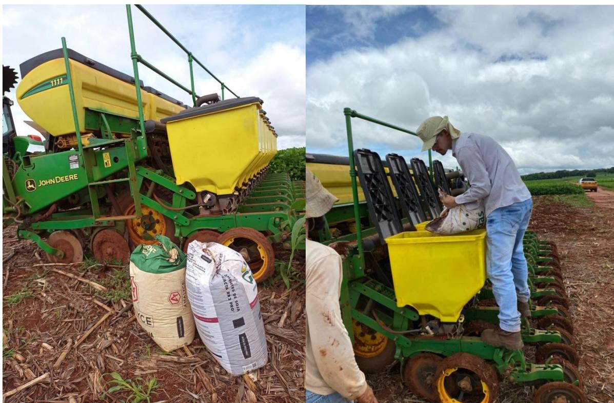
**Figura 4.** Semeadura das cultivares Brasmax FOCO® e TMG 7063®. Plantadeira John Deere (JD 1111® - 8 linhas), com distribuição a vácuo de sementes. Créditos de imagem: Baldo, 2022.
