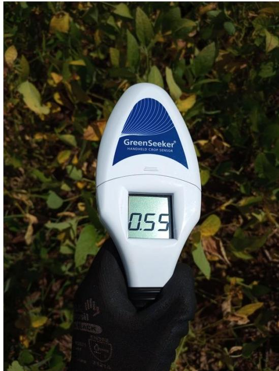
**Figura 8.** Análise de vigor através do aparelho Green Seeker Handheld Trimble®. O aparelho emite luz vermelha e infravermelho, posteriormente analisando a refletância de retorno. O sensor exibe o valor medido em termos de uma leitura NDVI na tela LCD. As leituras NDVI podem variar de 0,00 a 0,99, onde quanto maior a leitura, maior sanidade vegetal. **Baldo, 2022.**
