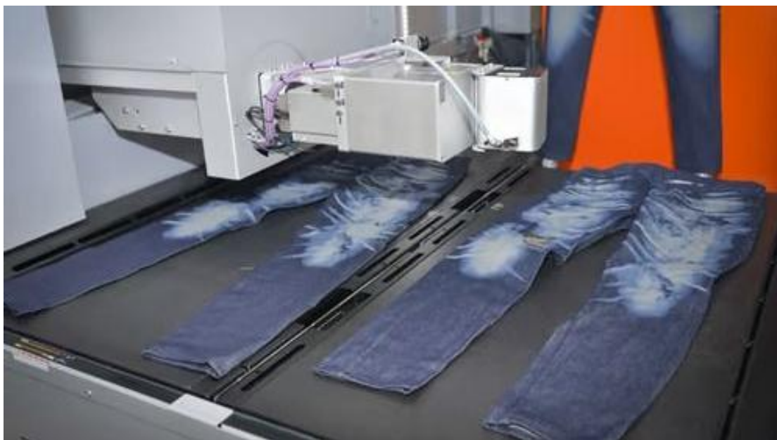
Fotografia 8 — Máquina de laser fazendo estampa em jeans
