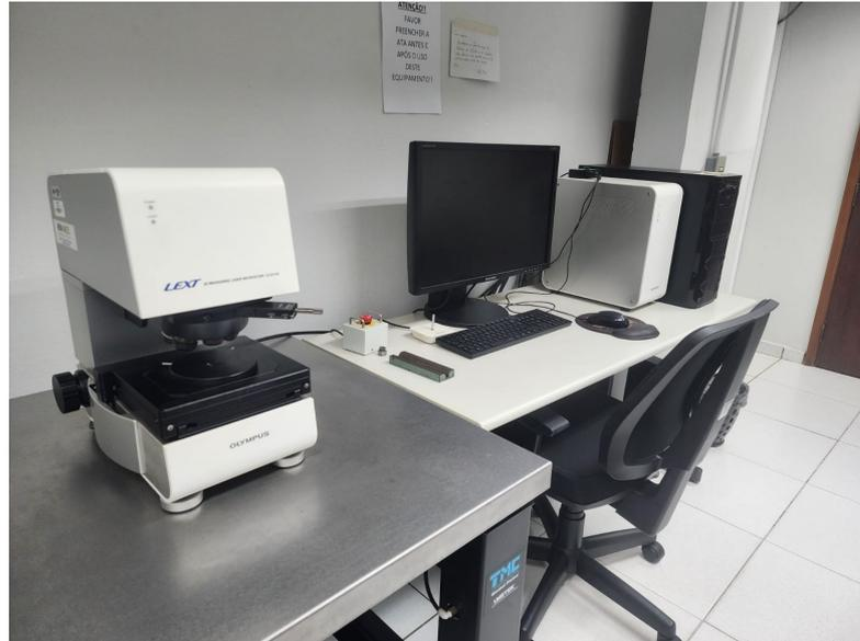
Figura 3.5. Microscópio Confocal de medição a laser LEXT OLS4100 da Olympus.
