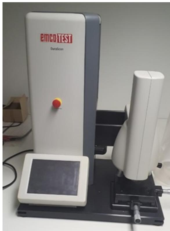
**Figura 3.8.** Microdurômetro da Emco Test modelo DuraScan 20.
