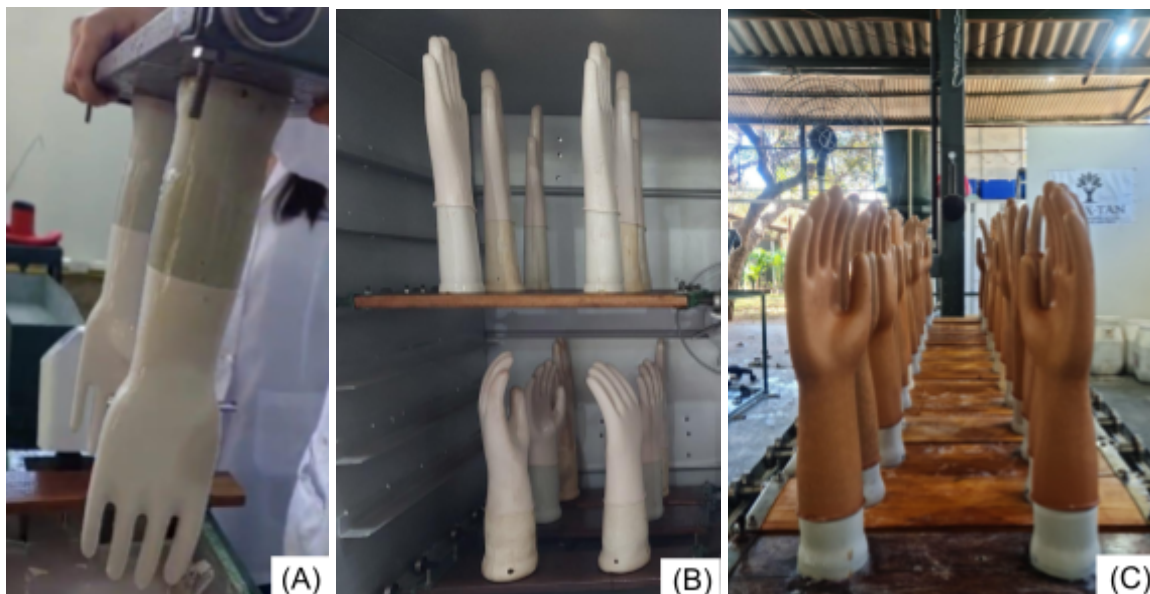
FIGURA 7 - Processo de produção piloto de luvas.
