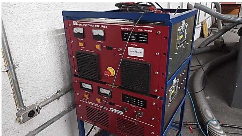
**Figura 3.2.5** - Amplificador da potência da bancada do teste. Fonte: Labcabos.
