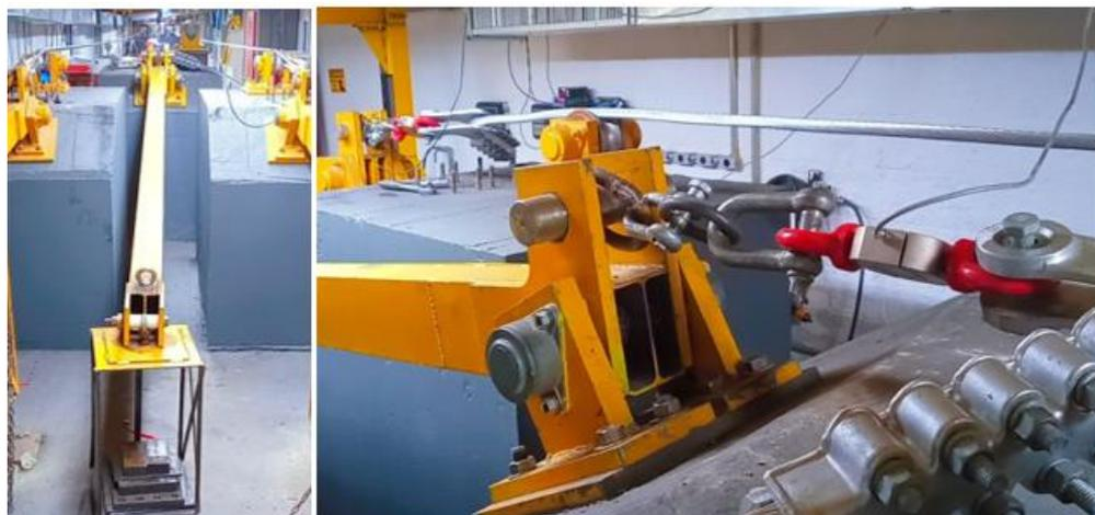
**Figura 3.3.5** - Talha do peso para controlar os valores da carga de tração.
