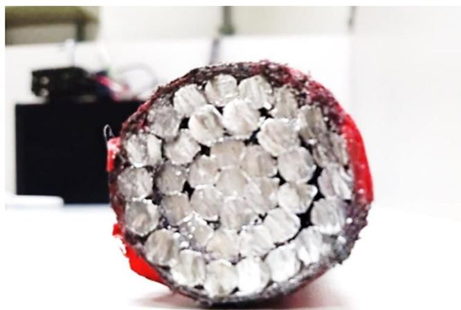
**Figura 3.2.1** - Seção transversal do Cabo CAL 1120 / 838 MCM.
