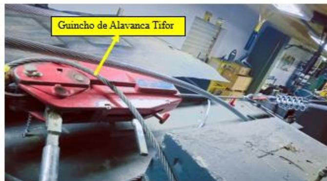
**Figura 3.3.3** - Guincho de Alavanca Tifor. Fonte: Labcabos.
