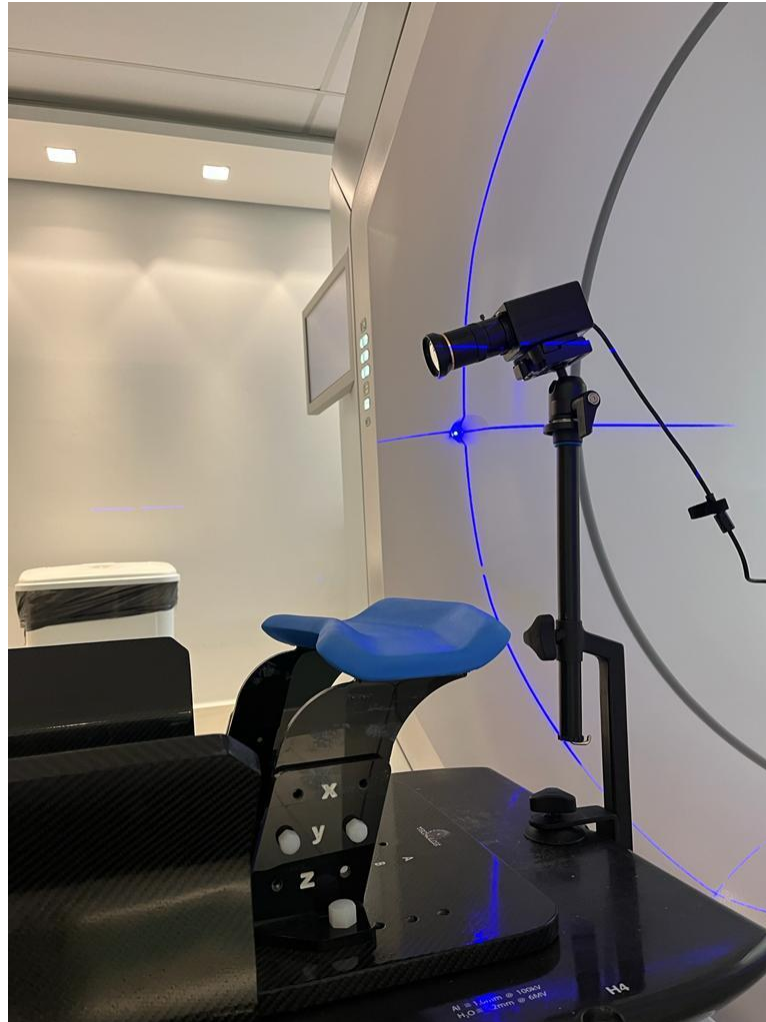
Figura 12. Montagem da câmera de vídeo em uma sala de um acelerador linear Halcyon. Nesse cenário, a câmara foi posicionada na mesa de tratamento através de um suporte desenvolvido in-house . Fonte: o Autor.
