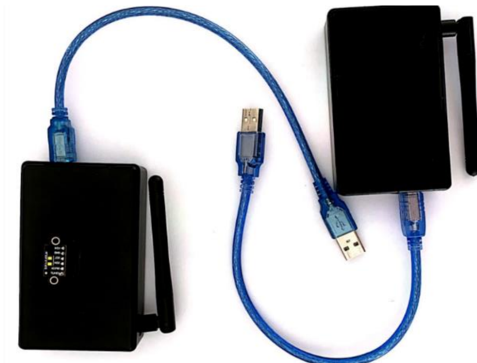
Figura 10. Componente do Sistema de Gerenciamento Respiratório Baseada no Sensor de Distância. Transmissor e receptor das leituras à esquerda e direita, respectivamente. Fonte: o Autor.
