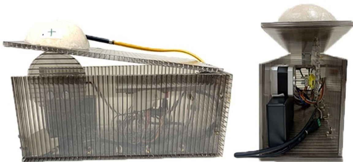
Figura 21. Objeto simulador construído utilizado na avaliação do sistema de gerenciamento respiratório: vista lateral e frontal. Fonte: o Autor.
