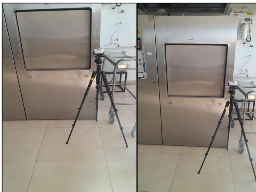
Figura 7. Medições de temperatura, umidade e dióxido de carbono (CO 2 ) na Central de Materiais Esterilizados (CME) do hospital, utilizando o termo-higrômetro digital com data Logger e Sensor de CO 2 MX1102. Fonte: Elaborado pelo autor
