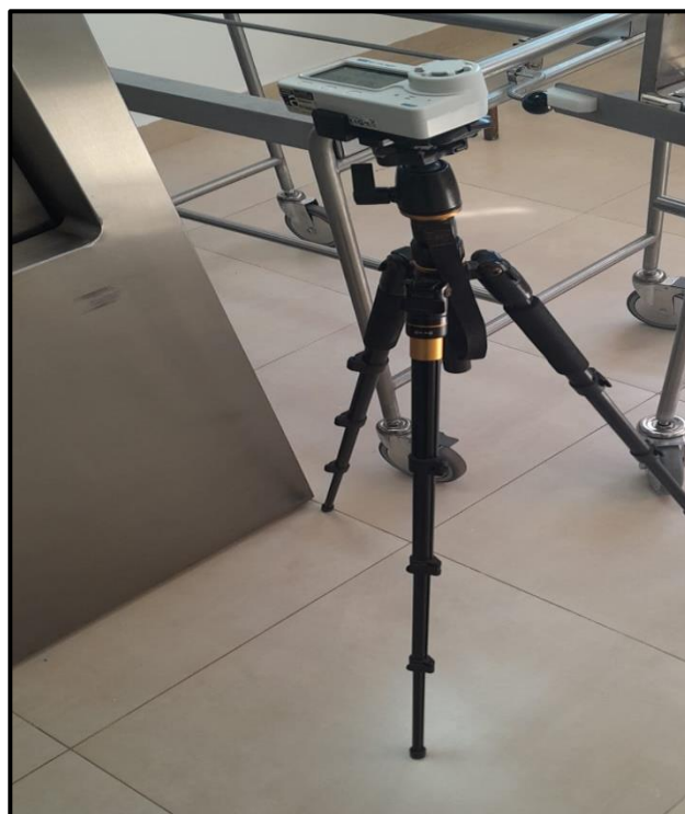
Figura 6. Medições de temperatura, umidade e dióxido de carbono (CO 2 ) na Unidade de Terapia Intensiva (UTI) do hospital, utilizando o termo-higrômetro digital com data Logger e Sensor de CO 2 MX1102. Fonte: Elaborado pelo autor
