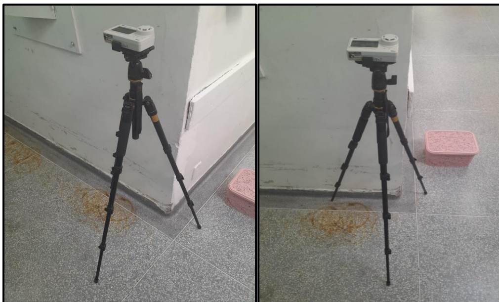
Figura 3. Medições de temperatura, umidade e dióxido de carbono (CO 2 ) no centro cirúrgico do hospital, utilizando o termo-higrômetro digital com data Logger e Sensor de CO 2 MX1102. Fonte: Elaborado pelo autor
