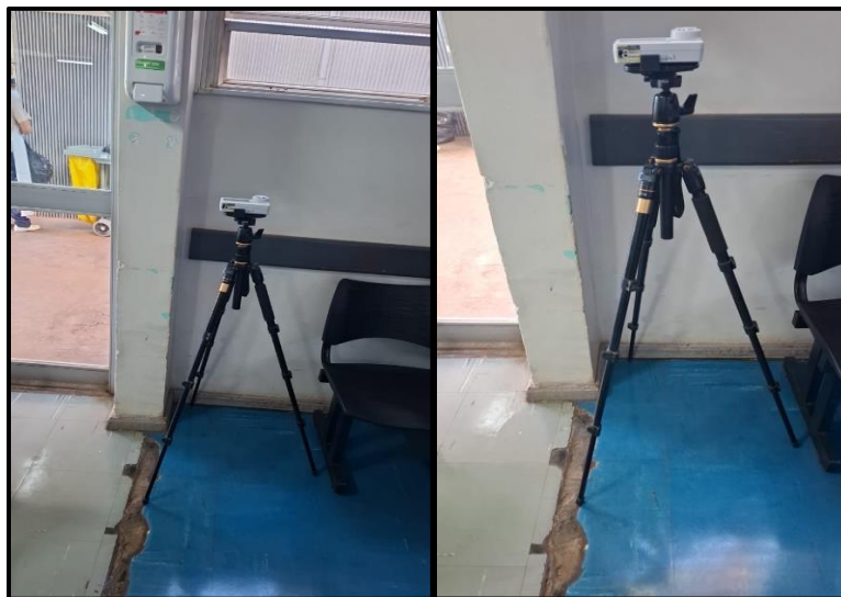
Figura 5. Medições de temperatura, umidade e dióxido de carbono (CO 2 ) na sala de espera da radiologia do hospital, utilizando o termo-higrômetro digital com data Logger e Sensor de CO 2 MX1102. Fonte: Elaborado pelo autor
