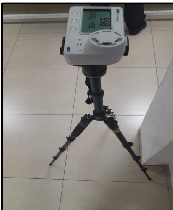
Figura 4. Medições de temperatura, umidade e dióxido de carbono (CO 2 ) no quarto de internação do hospital, utilizando o termo-higrômetro digital com data Logger e Sensor de CO 2 MX1102. Fonte: Elaborado pelo autor
