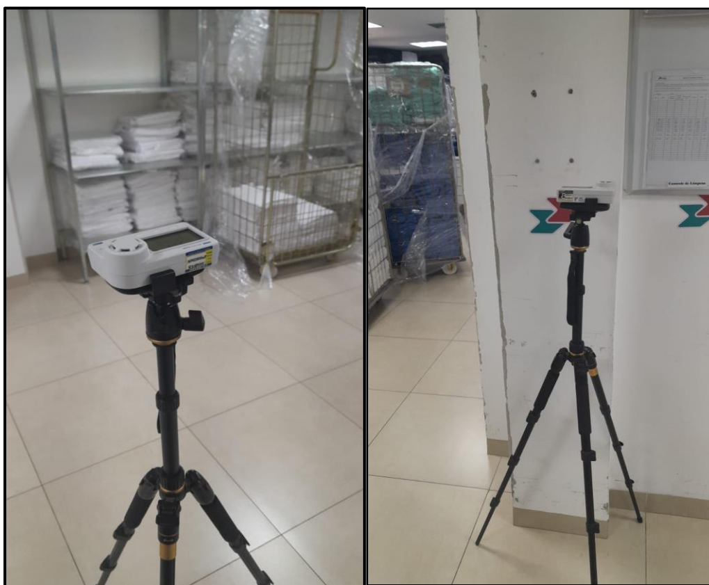
Figura 8. Medições de temperatura, umidade e dióxido de carbono (CO 2 ) na Hotelaria do hospital, utilizando o termo-higrômetro digital com data Logger e Sensor de CO 2 MX1102. Fonte: Elaborado pelo autor
