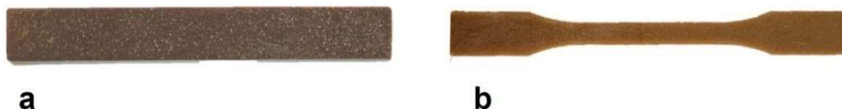
Figura 3.4 - Exemplos de corpos de prova: a) corpo de prova para os ensaios de absorção de água, perfil de densidade, DMA e dureza; b) corpo de prova para o ensaio de tração
