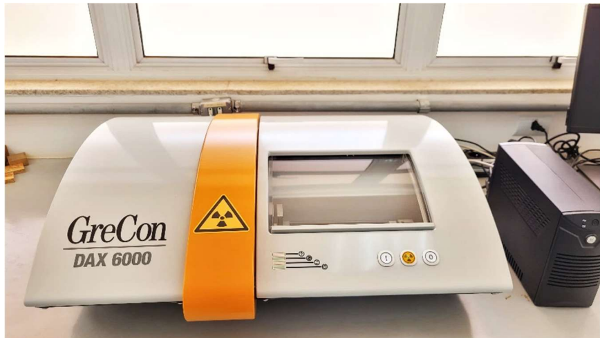
Figura 3.5 - Equipamento para medição do perfil de densidade
