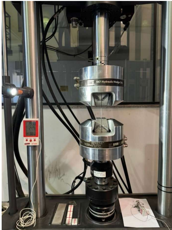
Figura 3.9 - Equipamento de ensaio de tração com célula de carga de 5 KN
