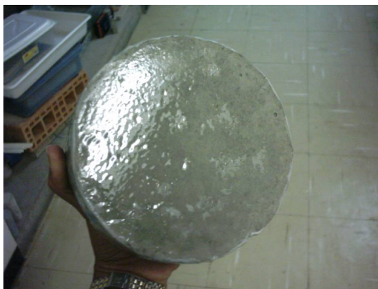
Figura 3.18. Aspecto da superfície dos corpos-de-prova no momento da leitura da massa.
