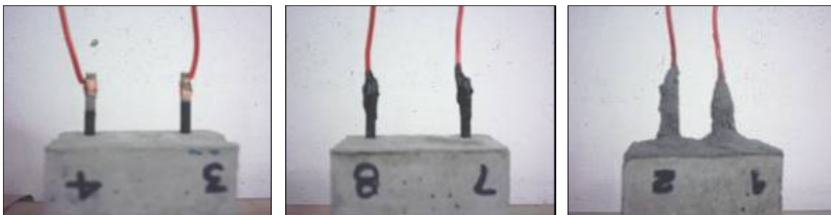
Figura 3.7. a) Conexão dos fios de cobre para a realização de medidas eletroquímicas; b) Isolamento com fita; c) Revestimento com resina epóxi.
