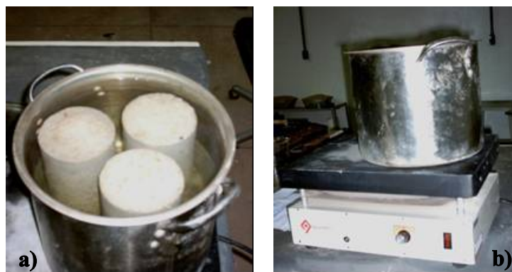
Figura 3.13. Ensaio de absorção por imersão. Fervura dos corpos-de-prova.
