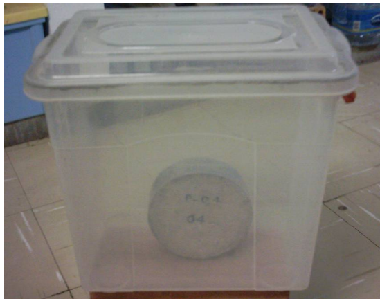
Figura 3.15. Corpo-de-prova armazenado para a pré-secagem.
