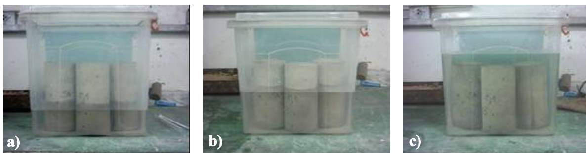
Figura 3.12. Ensaio de absorção por imersão. a) imersão de 1/3 do volume dos corpos-de-prova; b) imersão de 2/3 do volume dos corpos-de-prova e c) imersão total dos corpos-de-prova.
