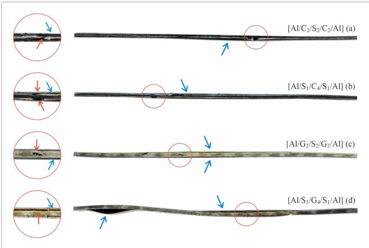
Figura 41 – Fotografias exibindo o desenvolvimento de danos após o ensaio de tração dos FMLs [Al/C<sub>2</sub>/S<sub>2</sub>/C<sub>2</sub>/Al] (a), [Al/S<sub>1</sub>/C<sub>4</sub>/S<sub>1</sub>/Al] (b), [Al/G<sub>2</sub>/S<sub>2</sub>/G<sub>2</sub>/Al] (c) e [Al/S<sub>1</sub>/G<sub>4</sub>/S<sub>1</sub>/Al] (d).
