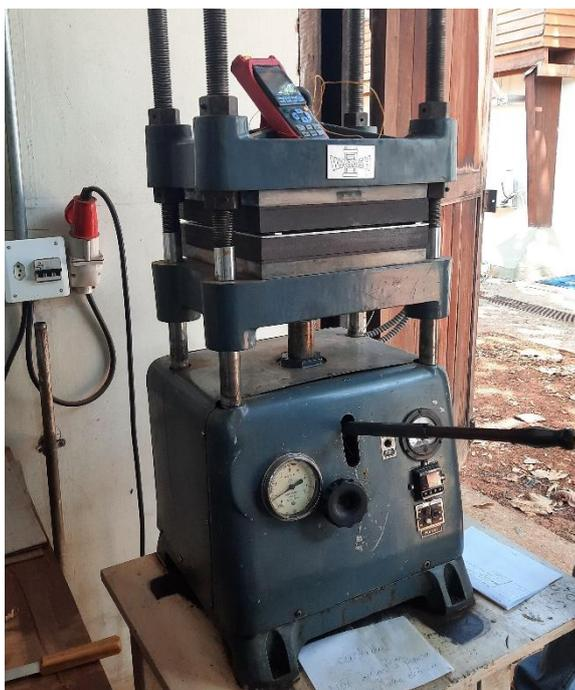
Figura 25 – Laminado em processo de cura em prensa hidráulica Wabash com pratos aquecidos.
