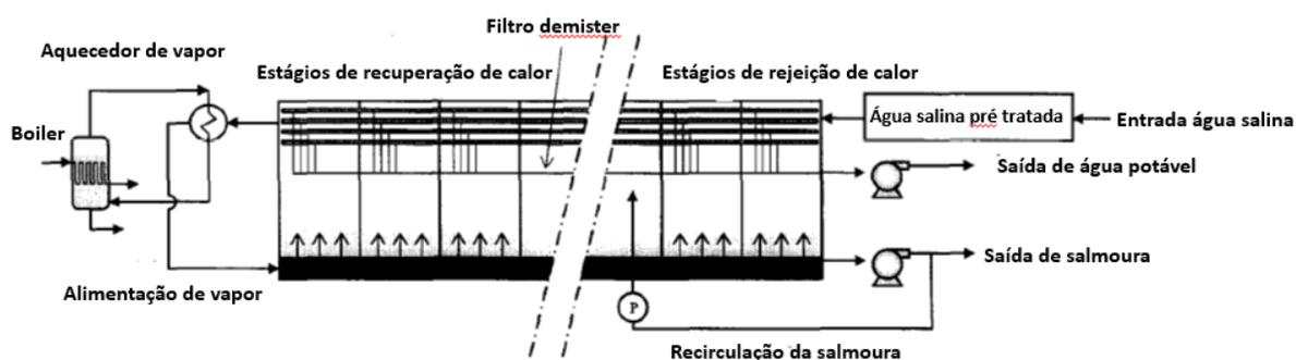
**Figura 2.17** - Princípio de funcionamento do processo de dessalinização térmica MSF (*multi-stage flash*) adaptado (VAN DER BRUGGEN; VANDECASTEELE, 2002)
