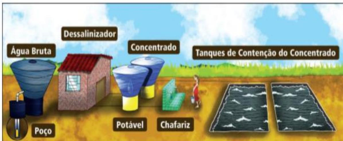
**Figura 2.11** - Representação esquemática do sistema de dessalinização adotado pelo Programa PAD
