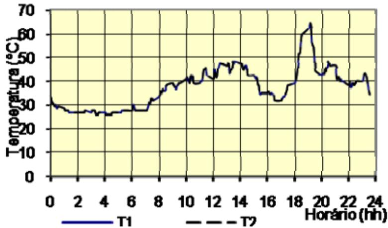
Figura 1.21: Dia típico de monitoramento em uma linha de 138 kV (NASCIMENTO et al., 2008).
