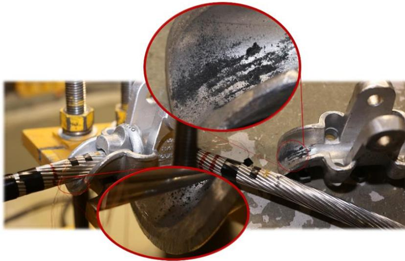
Figura 1.35: Pó de Al<sub>2</sub>O<sub>3</sub> no grampo de suspensão durante e após retirada da amostra (COSTA, 2024).
