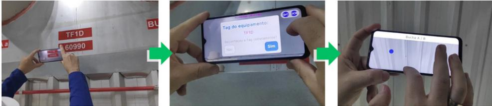
Figura 3 – Testes indoor de funcionamento da aplicação *mobile* (Android) utilizando dispositivo *smartphone*. Da esquerda para a direita, busca-se a *tag* do equipamento; identifica-a; logo, ativa-se a cena de RA implementando as interações cadastradas no equipamento pelo registro de dados.
