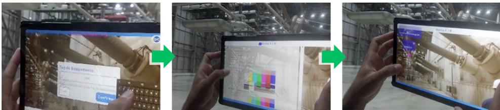
Figura 4 – Testes indoor de funcionamento da aplicação *mobile* (Android) utilizando dispositivo *tablet*. Da esquerda para a direita, explora-se a identificação manual do equipamento; acesso à interação de procedimentos; e, informações textuais.
