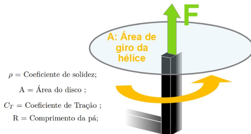
Figure 3.4 – Coeficientes de tração e momento devido ao arrasto da hélice
