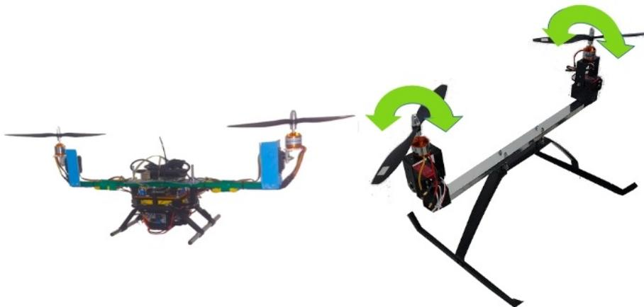
Figure 1.1 – Tiltrotor Bimotor - Movimentação de tilt dos motores de propulsão
